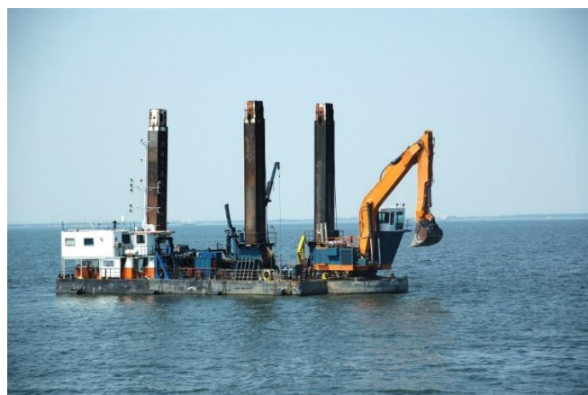
Σχήμα 1.27.: Βυθοκόρος με πτύο (vlmaritime.com)
