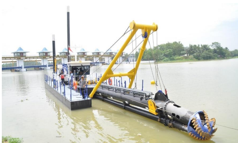
Σχήμα 1.28.: Βυθοκόρος με κοπτικό εργαλείο (gatimoimport.com)
