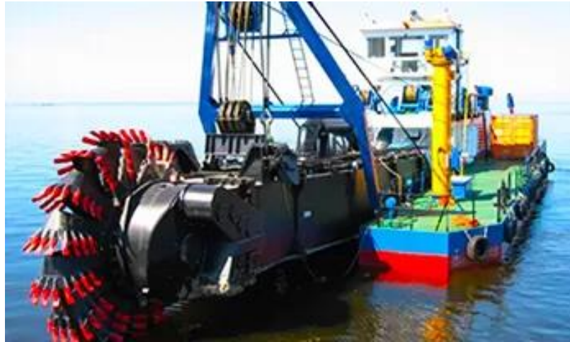
Σχήμα 1.29.: Βυθοκόρος με κοπτικό τροχό (leaderdredger.com)
