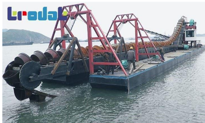
Σχήμα 1.26.: Βυθοκόρος με κάδους (trodatgroup.com)
