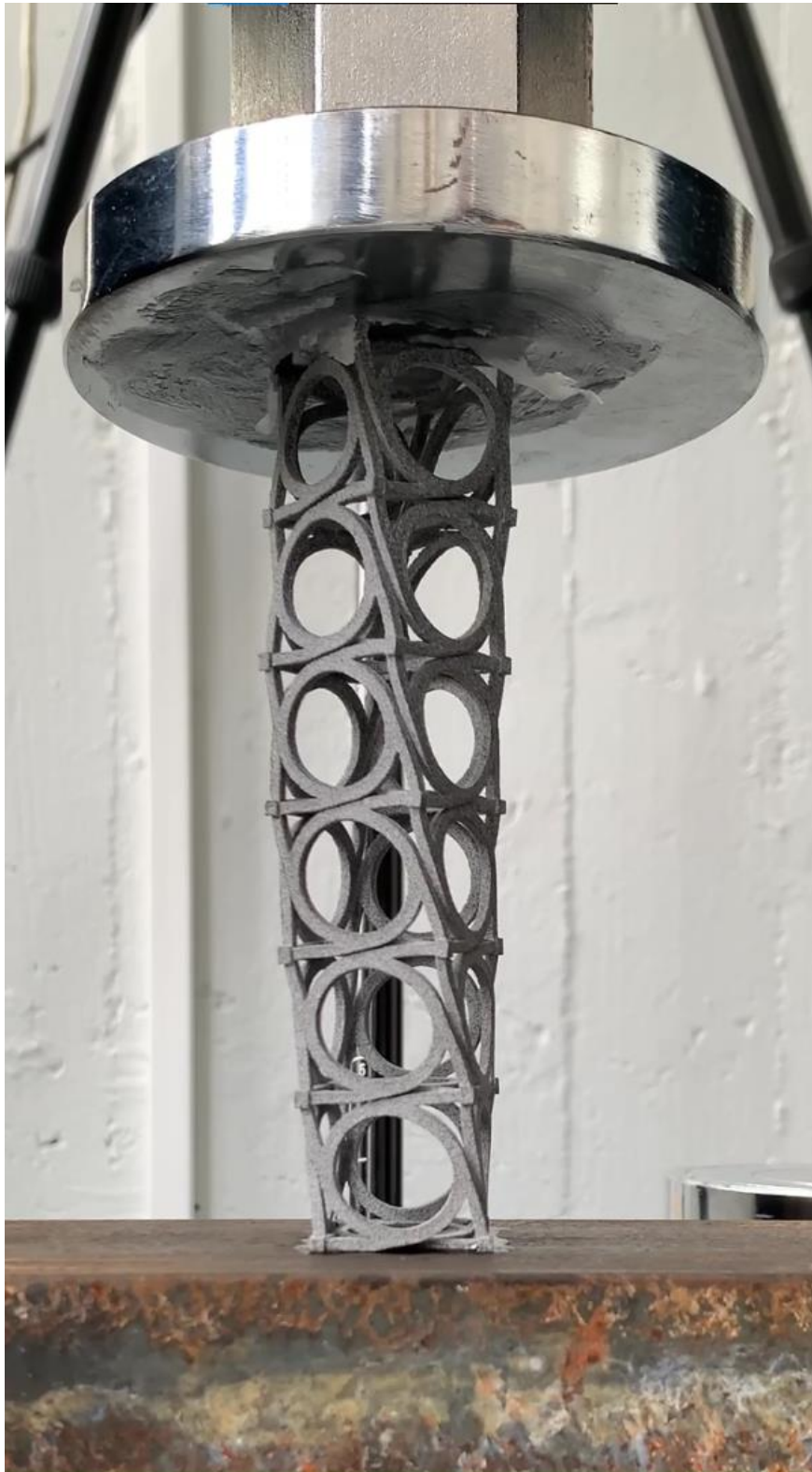
Εικόνα 130: Στιγμιότυπο την Στιγμή της Αστοχίας - Δομή 2
