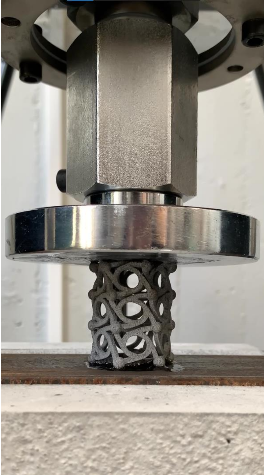
Εικόνα 133: Στιγμιότυπο την Στιγμή της Αστοχίας - Δομή 3
