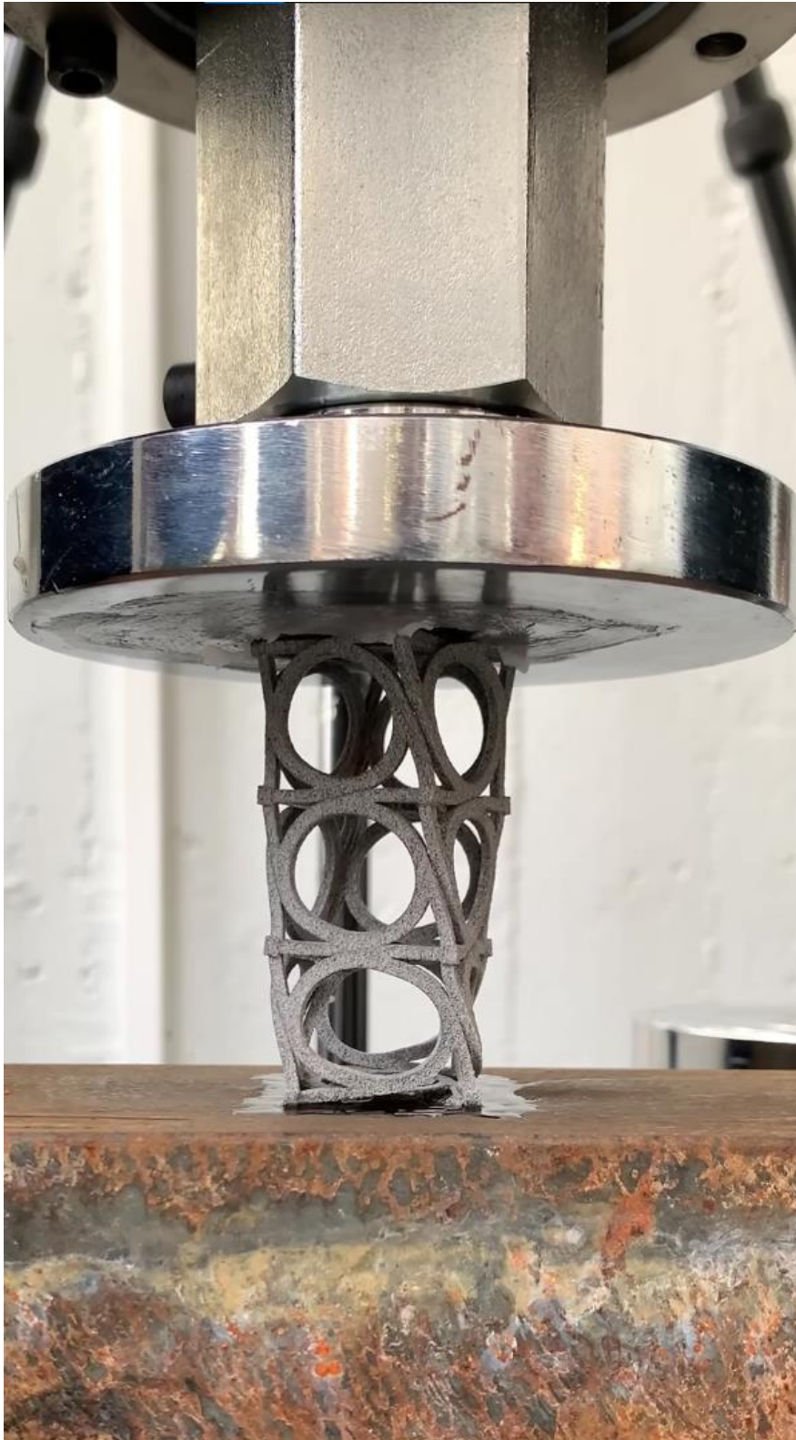
Εικόνα 127: Στιγμιότυπο την Στιγμή της Αστοχίας – Δομή 1
