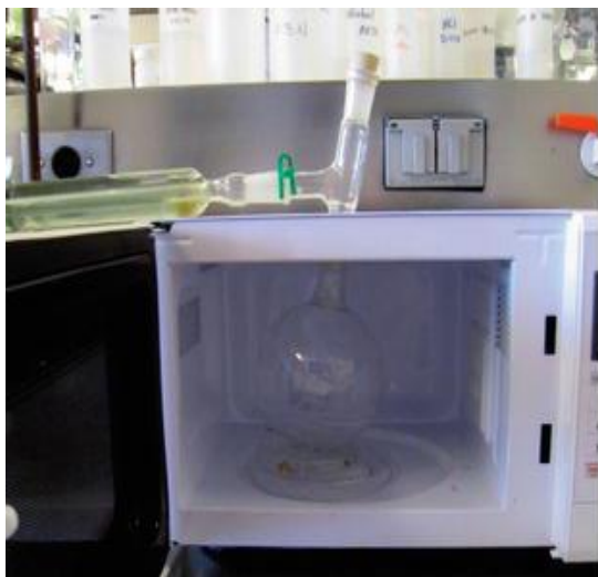
Εικόνα 9: Απεικόνιση ξηρής απόσταξης με την χρήση μικροκυμάτων
