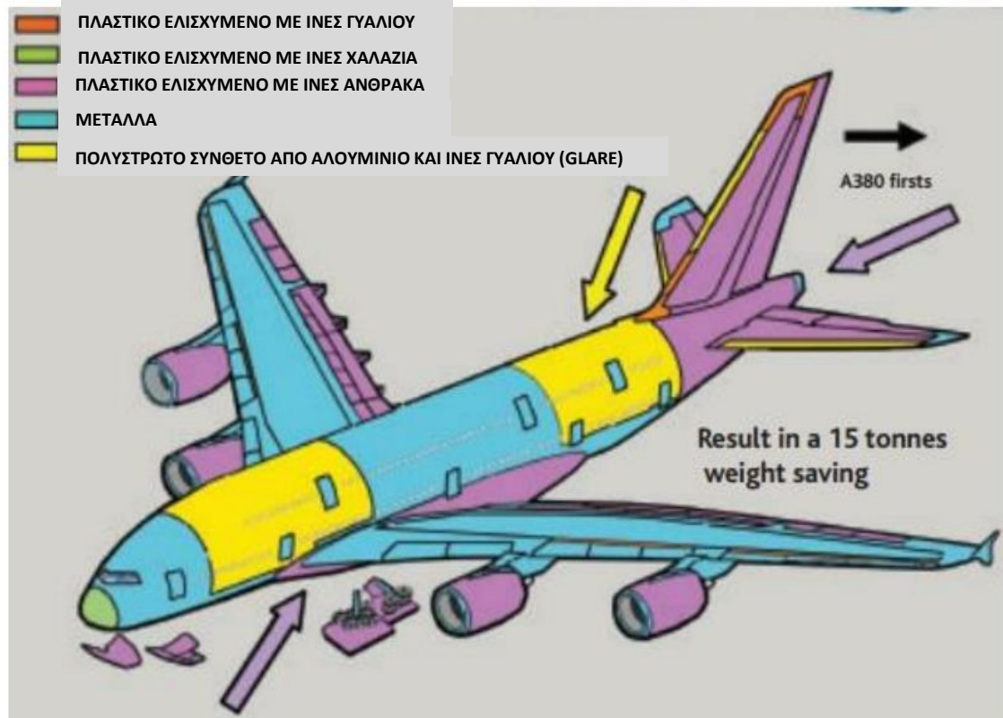
Σχ. 2.7 Σύνθεση υλικών για το Airbus A380.
