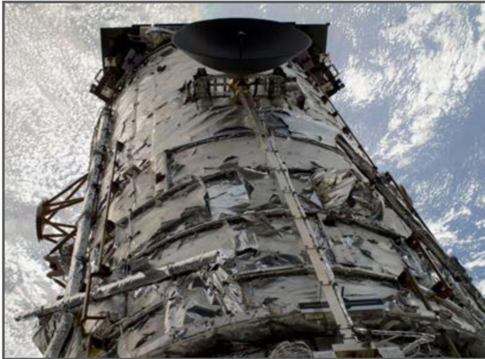
Σχ. 6.1 Φθορά της εξωτερικής στρώσης ενός πολύστρωματικού υλικού αλουμινίου – Teflon του διαστημικού τηλεσκοπίου Hubble, μετά από 19 χρόνια στο διαστημικό περιβάλλον. [50]
