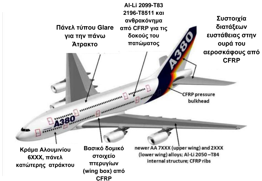
Σχ. 2.9 Διάφορες εφαρμογές CFRP στο μοντέλο A380. [9]
