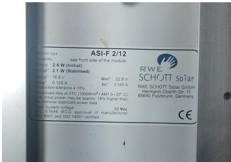
Εικόνα 55. Η πινακίδα με τα χαρακτηριστικά του ΦΒ της κατασκευής
