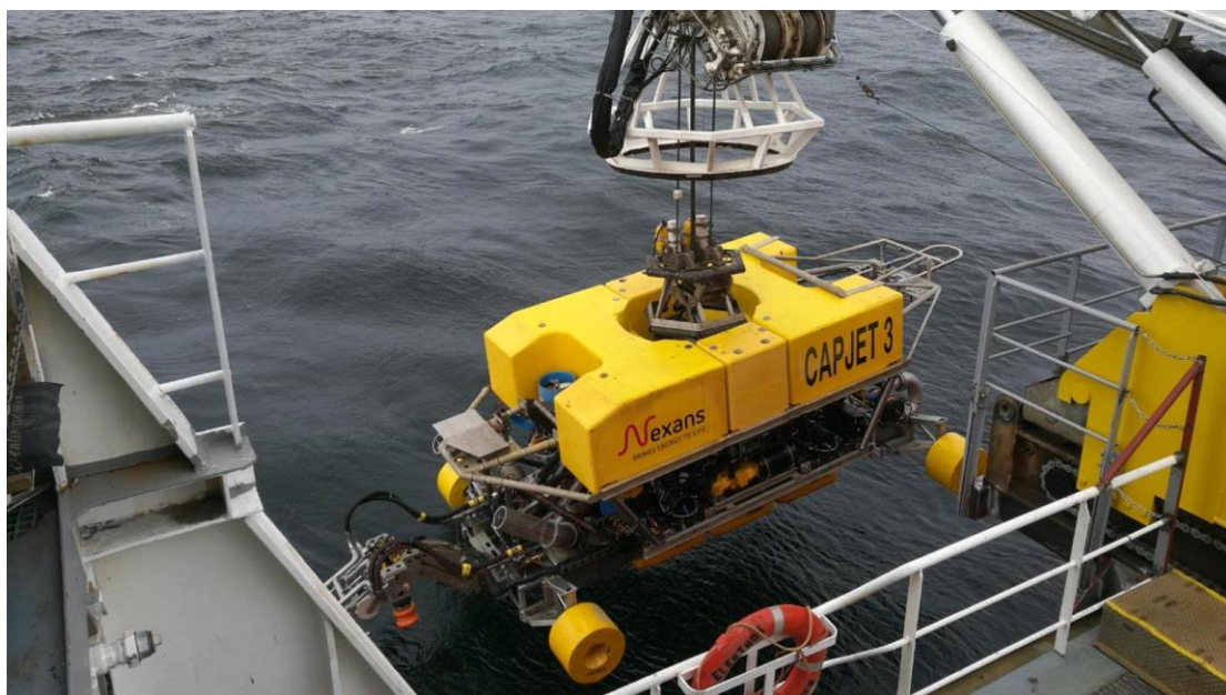
ΕΙΚΟΝΑ 62. ΤΟ ROV ΤΗΣ NEXANS ΜΟΝΤΕΛΟ CAPJET 3 ΕΤΟΙΜΟ ΠΡΟΣ ΒΥΘΙΣΗ ΣΤΟΝ ΙΝΔΙΚΟ ΩΚΕΑΝΟ ΒΑΘΟΥΣ 7KM.
