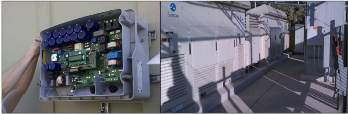
Εικόνα 4-2 Μετατροπείς: κουτί inverter μικρής κλίμακας για οικιακή χρήση (αριστερά) και μετατροπείς κλίμακας Satcon utility (δεξιά)( https://www.e-education.psu.edu/eme812/node/681 )
