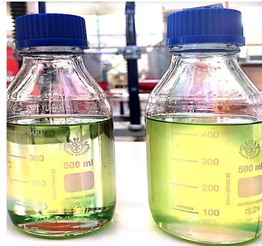
Εικ 9: Νανοέλαιο Al 2 O 3 σε μονωτικό έλαιο εστέρα FR3 σε συγκεντρώσεις 0.002% (δεξιά) w/w και 0.016% w/w(αριστερά)
