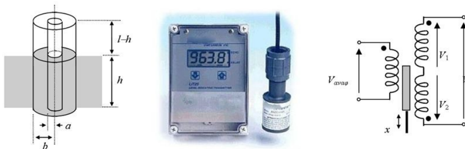
Σχήμα 2-20: Αρχή λειτουργίας αισθητήρα στάθμης
