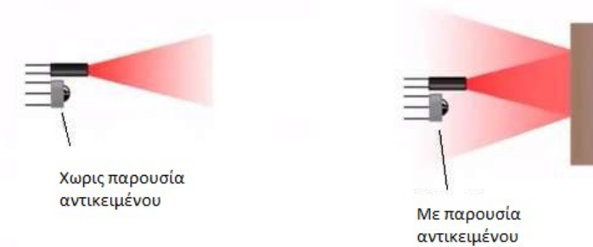
Σχήμα 2-19: Υπέρυθροι αισθητήρες, λειτουργία
