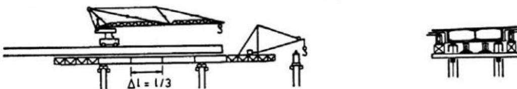
εικόνα 2.3.4: Κλασική Μέθοδος Προβολοδόμησης με τη χρήση βοηθητικών φορέων
