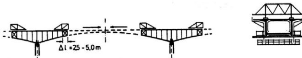
εικόνα 2.3.6: Μέθοδος Σταδιακής Προώθησης (nomoskopio)
