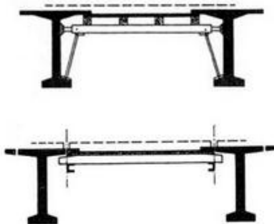
σχήμα 2.5.6.1: σκυροδέτηση της πλάκας κυκλοφορίας γίνεται με τη βοήθεια καταλλήλου ξυλότυπου (nomoskopio)
