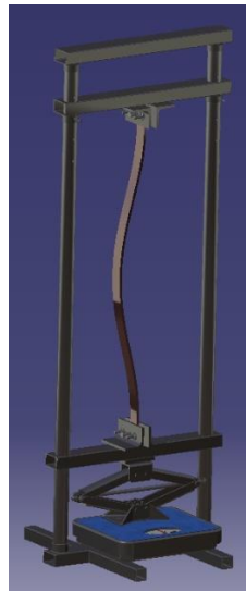
Εικ. 22: Δοκίμιο σε αστοχία λόγω λυγισμού.
