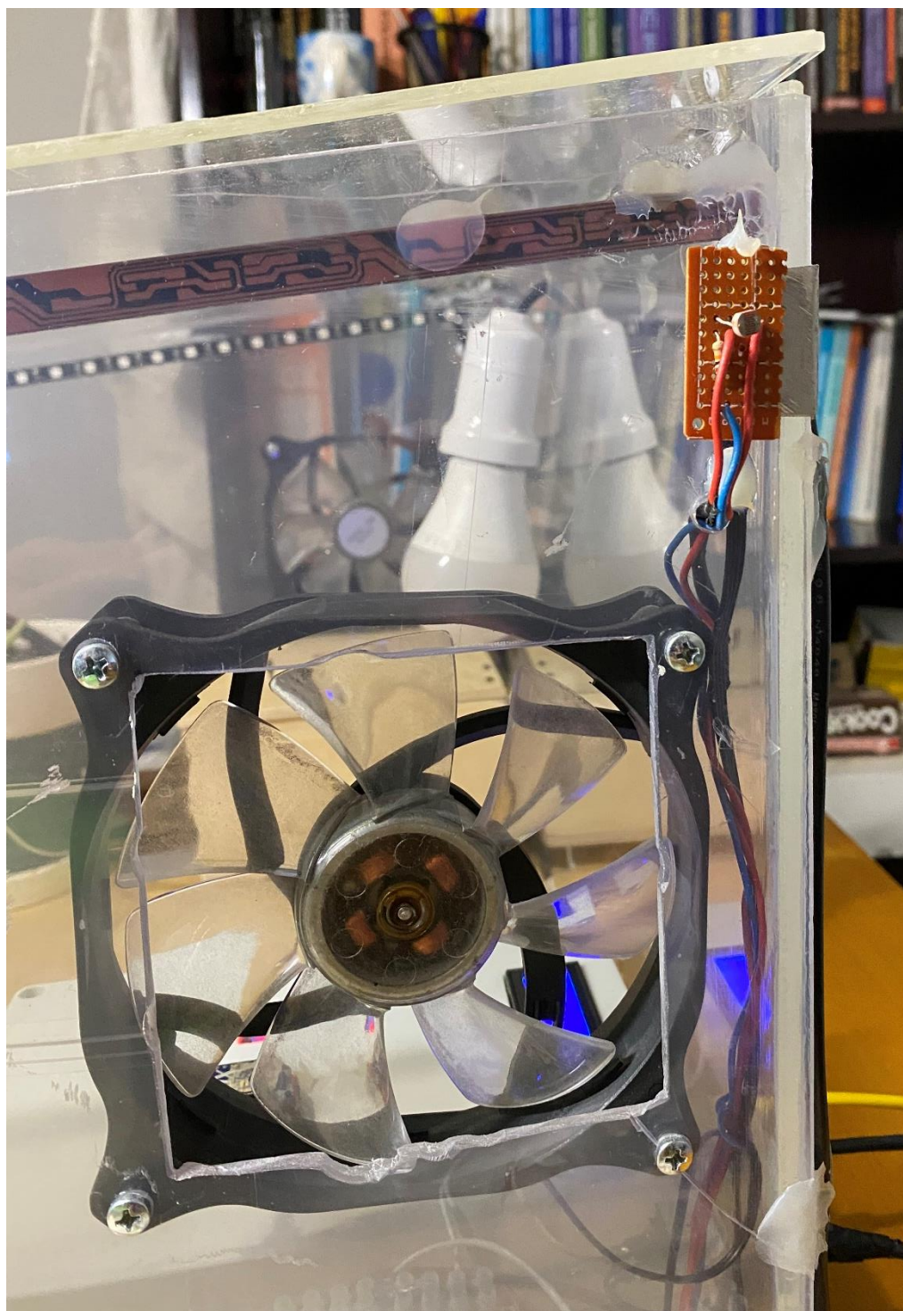
Εικόνα 4.54 Δεξιά όψη που απεικονίζει τον ανεμιστήρα ψύξης και το εξωτερικό LDR.
