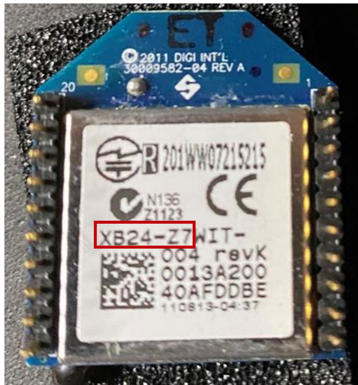
Εικόνα 4.33 Το πίσω μέρος του Xbee που φαίνεται κυκλωμένο το Product Family
