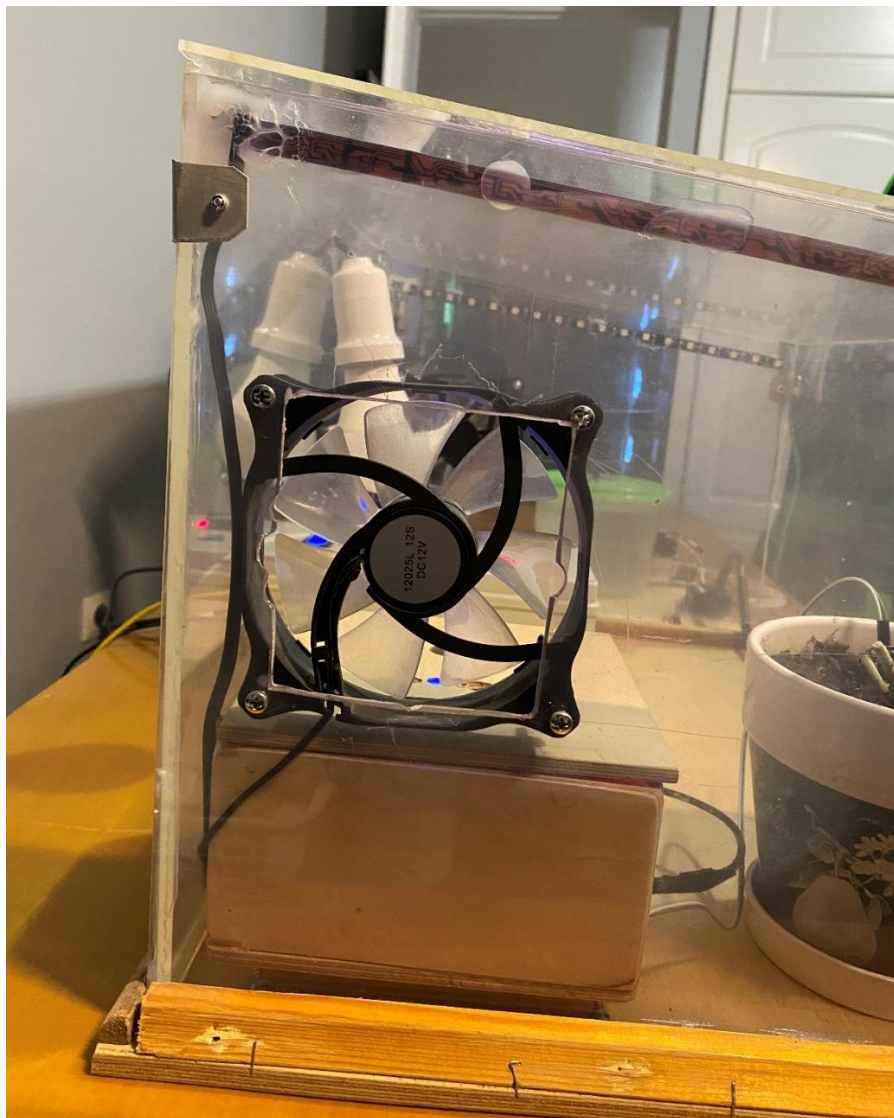
Εικόνα 4.53 Αριστερή όψη θερμοκήπιο που απεικονίζει των ανεμιστήρα εξαερισμού..
