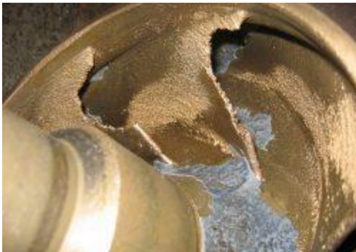
Εικόνα 55: Τα αποτελέσματα του φαινομένου της σπηλαιώσης στην φτερωτή μιας αντλίας νερού
