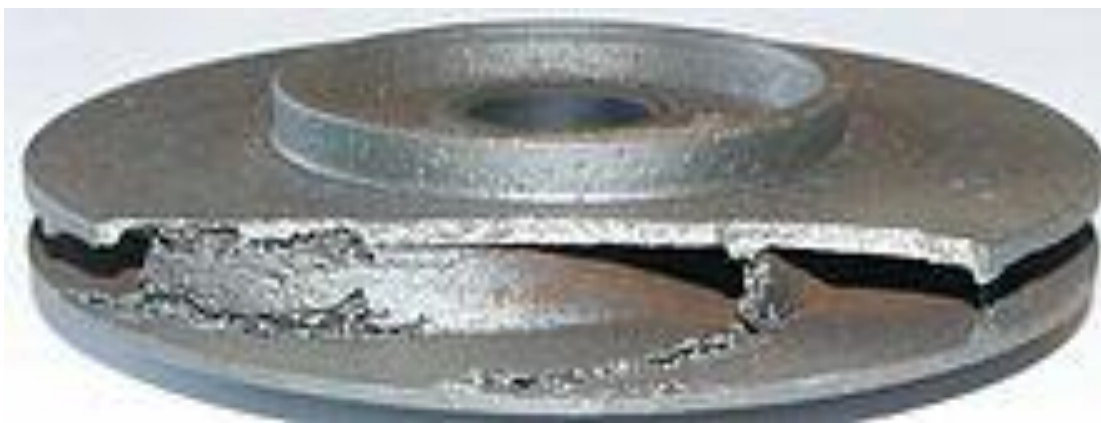
Εικόνα 53: Αποκόλληση υλικού λόγω του φαινομένου της σπηλαιώσης
