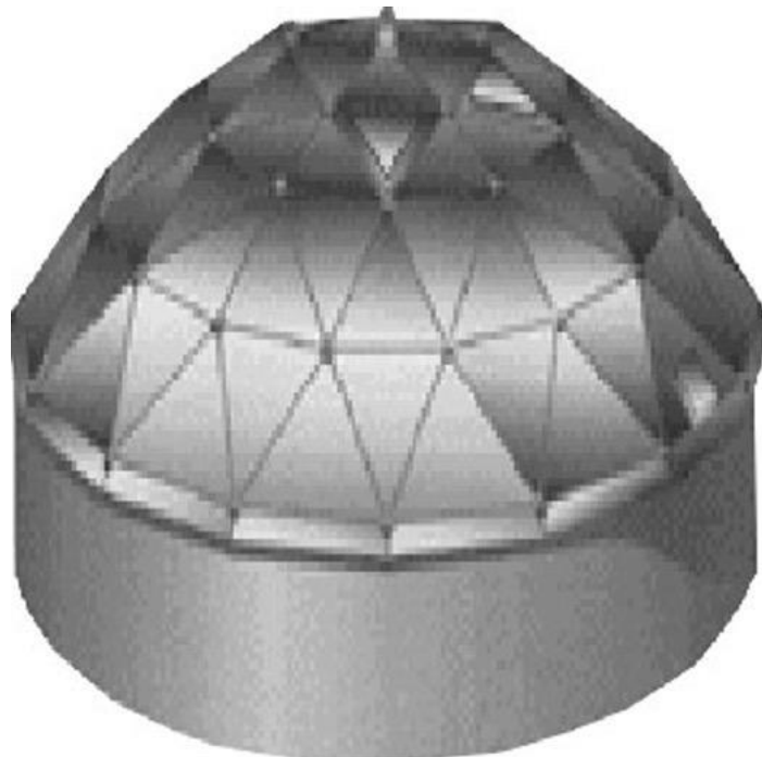
Εικόνα 41: Δεξαμενή πλωτής οροφής με θόλο
