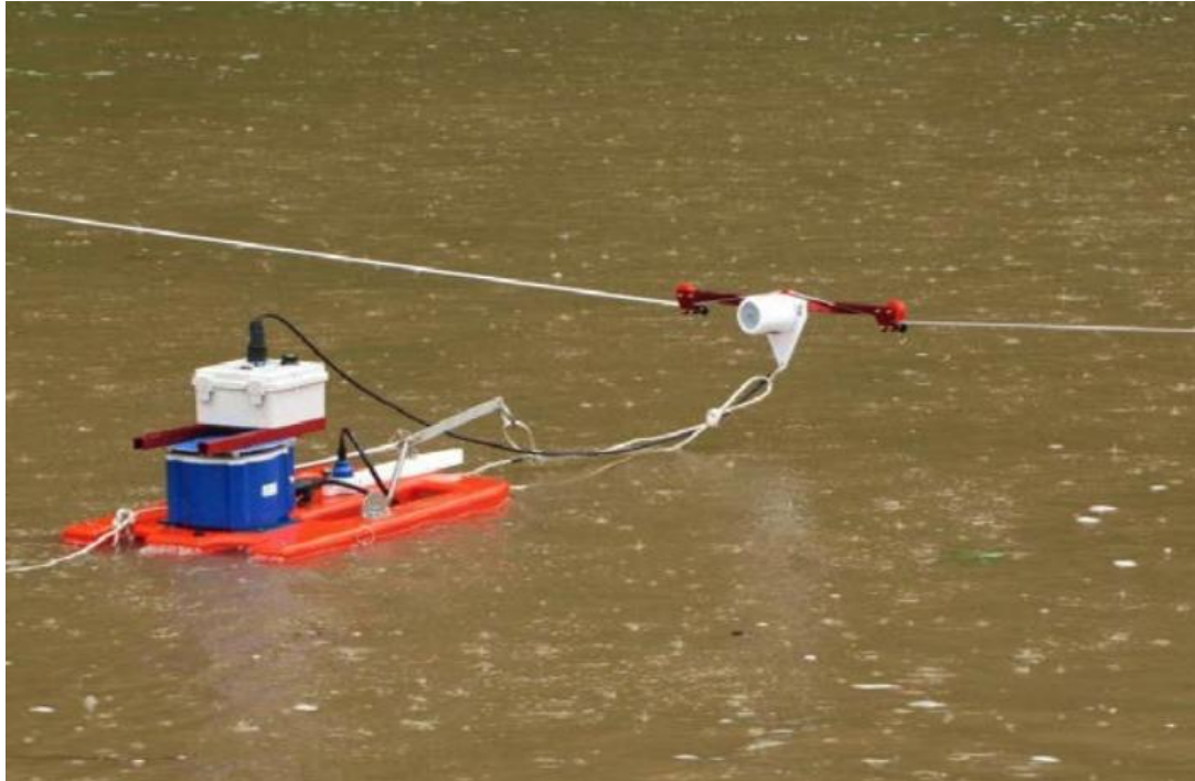
Σχήμα 3.2: Μέτρηση της ροής σε ποτάμι
