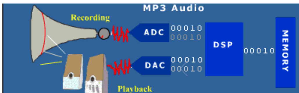
Εικόνα 2-25 DSP σε μια συσκευή αναπαραγωγής ήχου MP3 [7]
