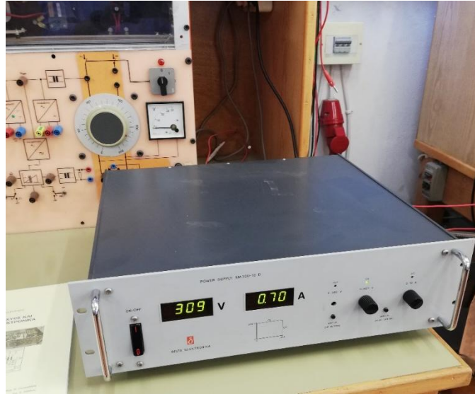
Εικόνα 5-13 Το τροφοδοτικό DC τάσης για τάση εισόδου 309V
