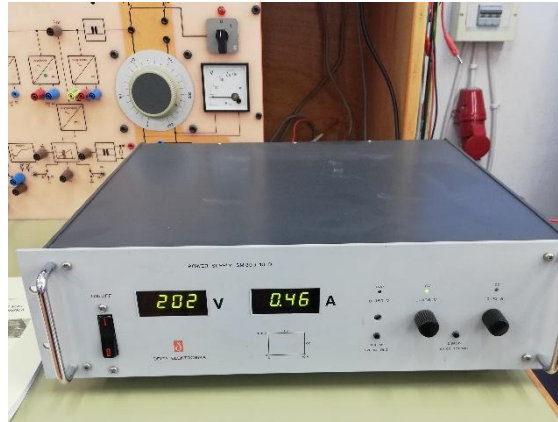
Εικόνα 5-11 Το τροφοδοτικό DC τάσης για τάση εισόδου 200 V
