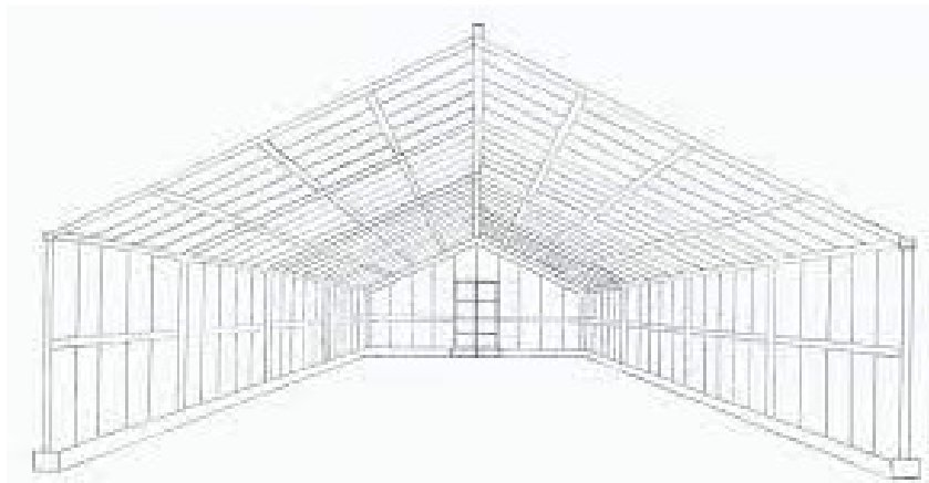
Εικόνα 4: Κατασκευαστική μονάδα αμφικλινούς θερμοκηπίου.
