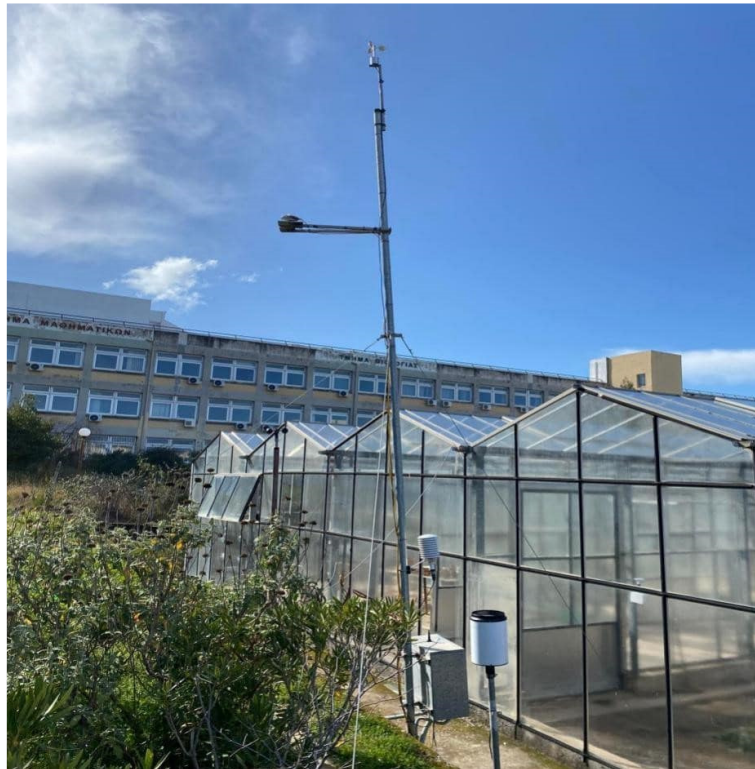
Εικόνα 14: Αυτόματος Μετεωρολογικός Σταθμός για την καταγραφή των εξωτερικών περιβαλλοντικών συνθηκών. Διακρίνονται όλοι οι προαναφερθέντες αισθητήρες.
