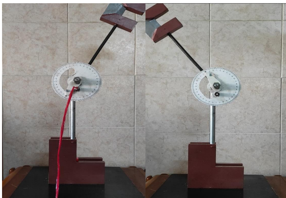
Εικόνα 76 : Αρχική και τελική θέση εκκρεμούς στη δοκιμή PLA (6x6x44mm).
