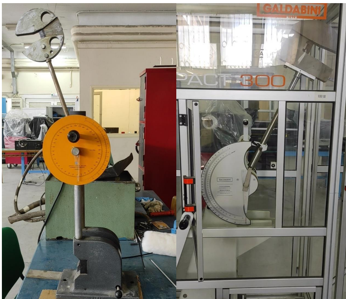
Εικόνα 73 : TERCO MT220 (αριστερή φωτογραφία) και GALDABINI IMPACT 300 (δεξιά φωτογραφία).
