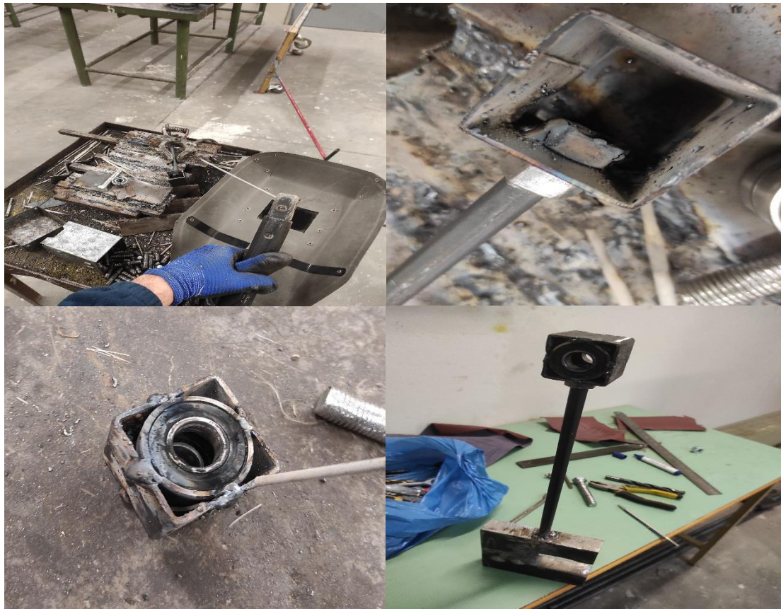
Εικόνα 53 : Στάδια συγκόλλησης του συστήματος περιστροφής.
