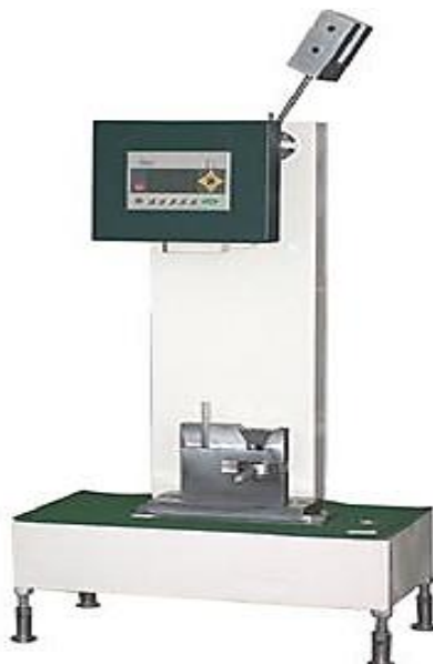
Εικόνα 16 : Μηχανή κρούσης Izod.
