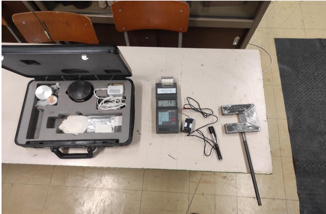
Εικόνα 55 : Μέτρηση σκληρότητας της σφύρας πριν τη κατεργασία βαφής με το φορητό σκληρόμετρο με αποτέλεσμα 131 HB.
