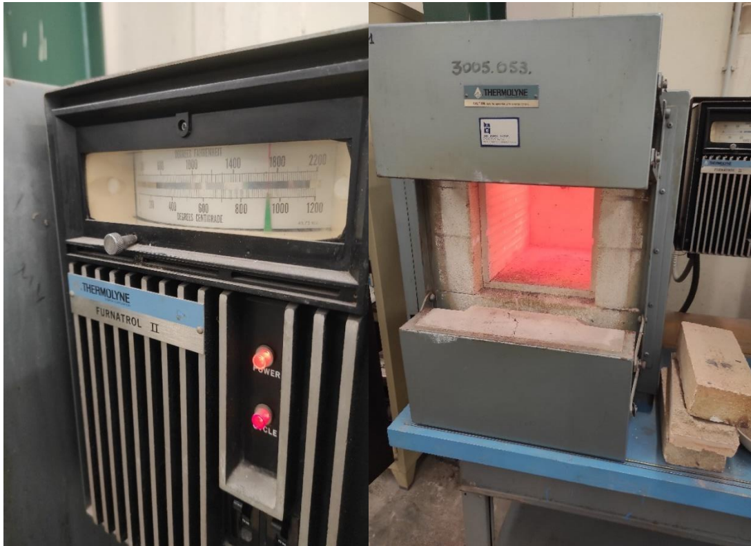
Εικόνα 57 : Προθέρμανση του φούρνου στην επιθυμητή θερμοκρασία .
