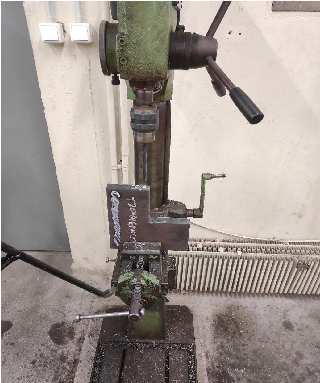
Εικόνα 44 : Κατεργασία διάτρησης των βραχιόνων της βάσης χρησιμοποιώντας ένα κάθετο δράπανο της σχολής.
