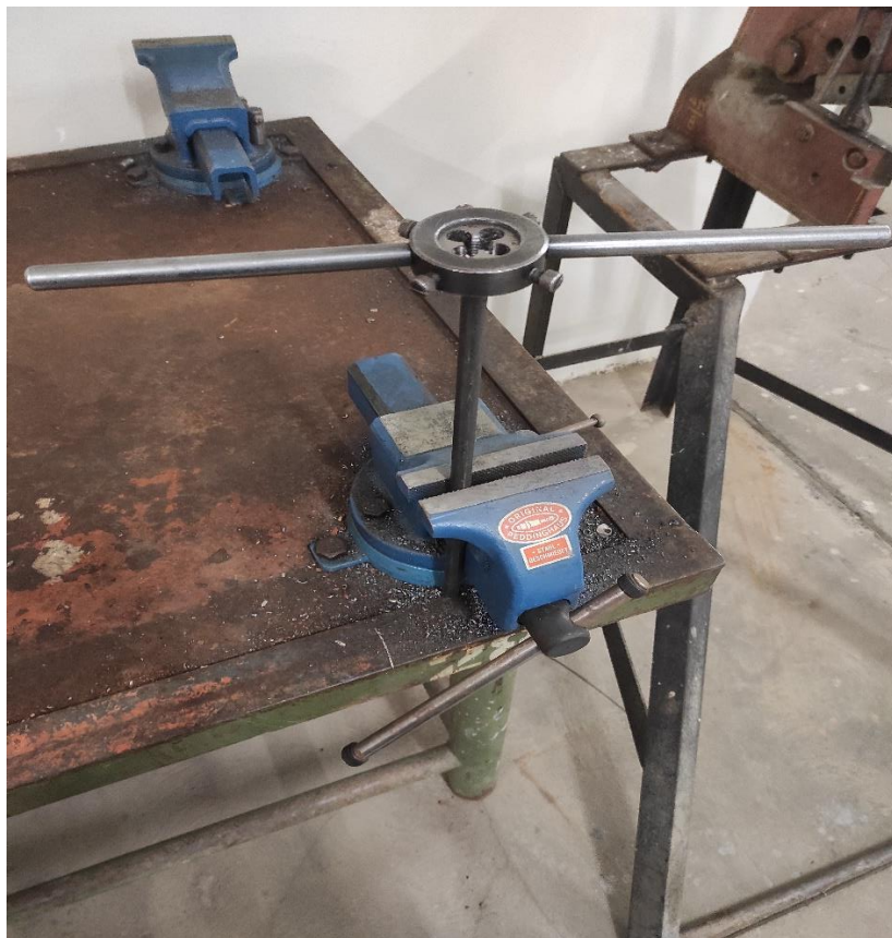
Εικόνα 52 : Δημιουργία σπειρώματος στο βραχίονα του εκκρεμούς χειροκίνητα με φιλιέρα.
