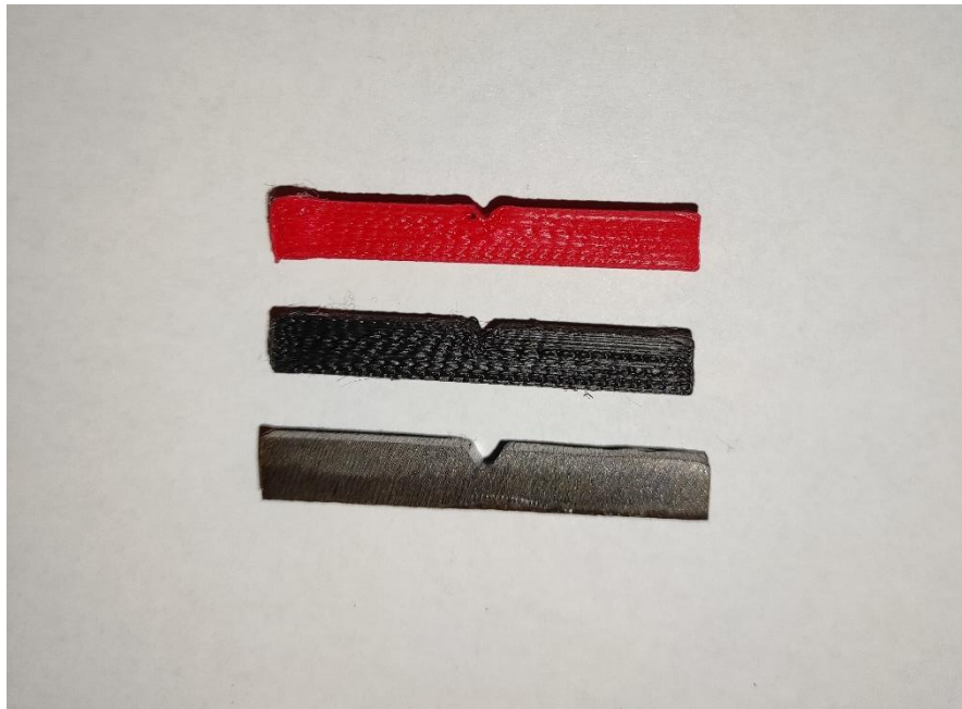
Εικόνα 70 : 1)Δοκίμιο PLA (κόκκινο χρώμα), 2)Δοκίμιο ABS (μαύρο χρώμα), 3) Δοκίμιο χυτοσιδήρου (γκρι χρώμα).
