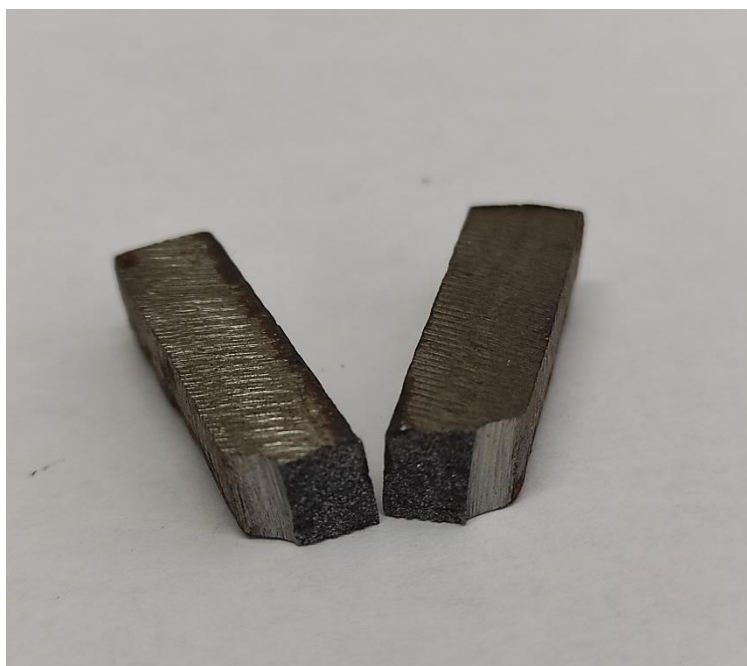
Εικόνα 85 : Δοκίμιο χυτοσιδήρου μετά τη κρούση.
