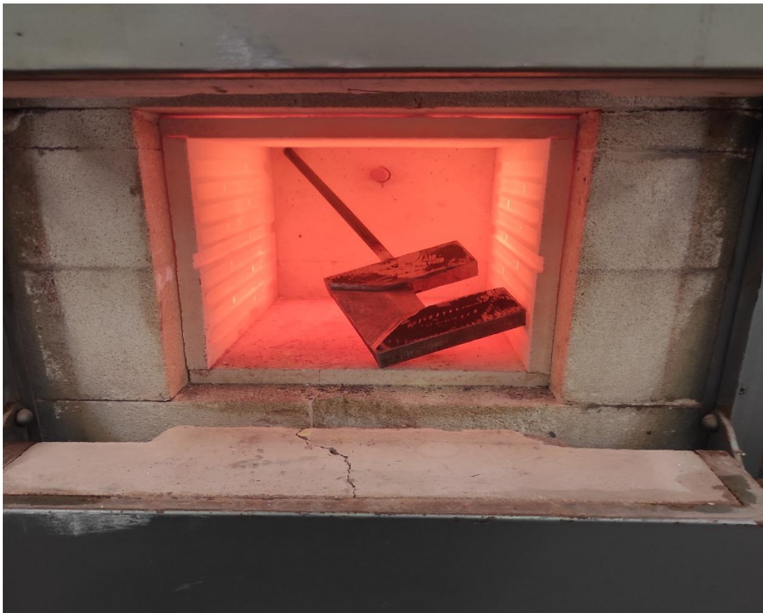
Εικόνα 58 : Τοποθέτηση της σφύρας στο χώρο θέρμανσης.
