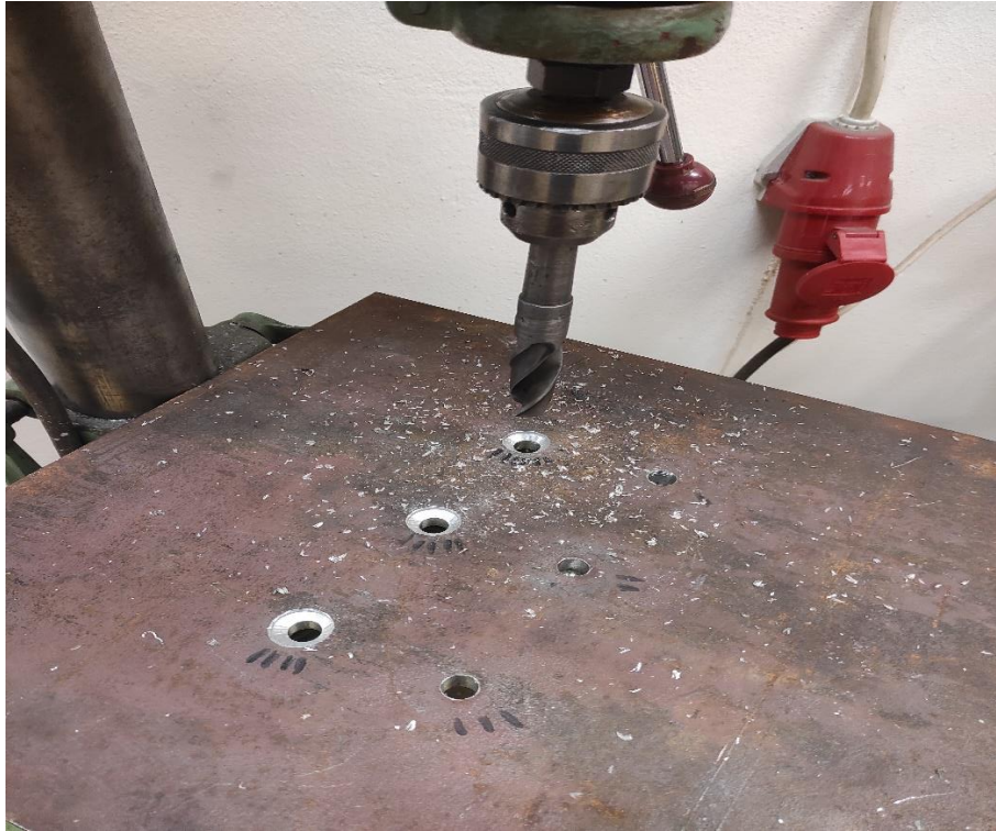
Εικόνα 47 : Φρεζάρισμα οπών για να μη προεξέχουν οι κοχλίες σύνδεσης.
