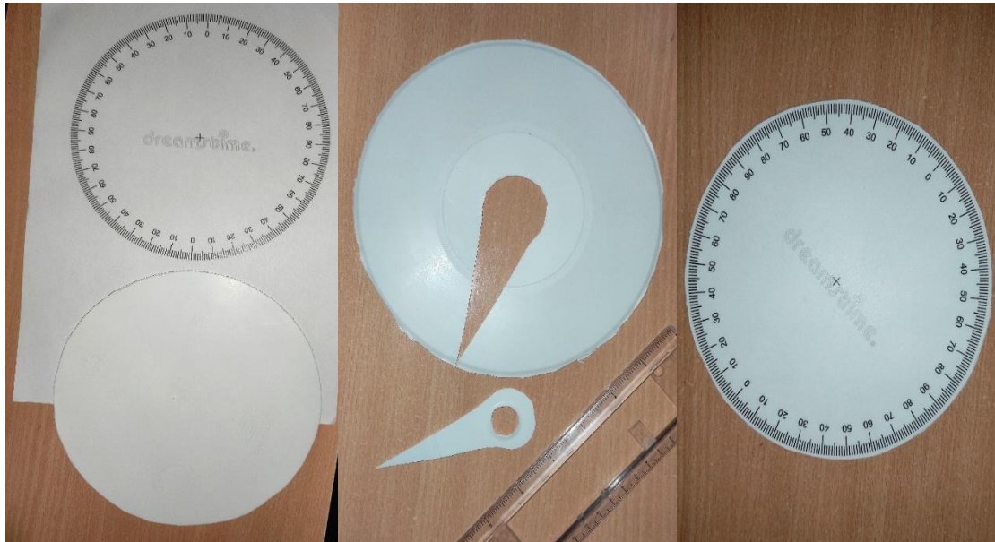
Εικόνα 62 : Κατασκευή συστήματος μέτρησης της γωνίας περιστροφής.
