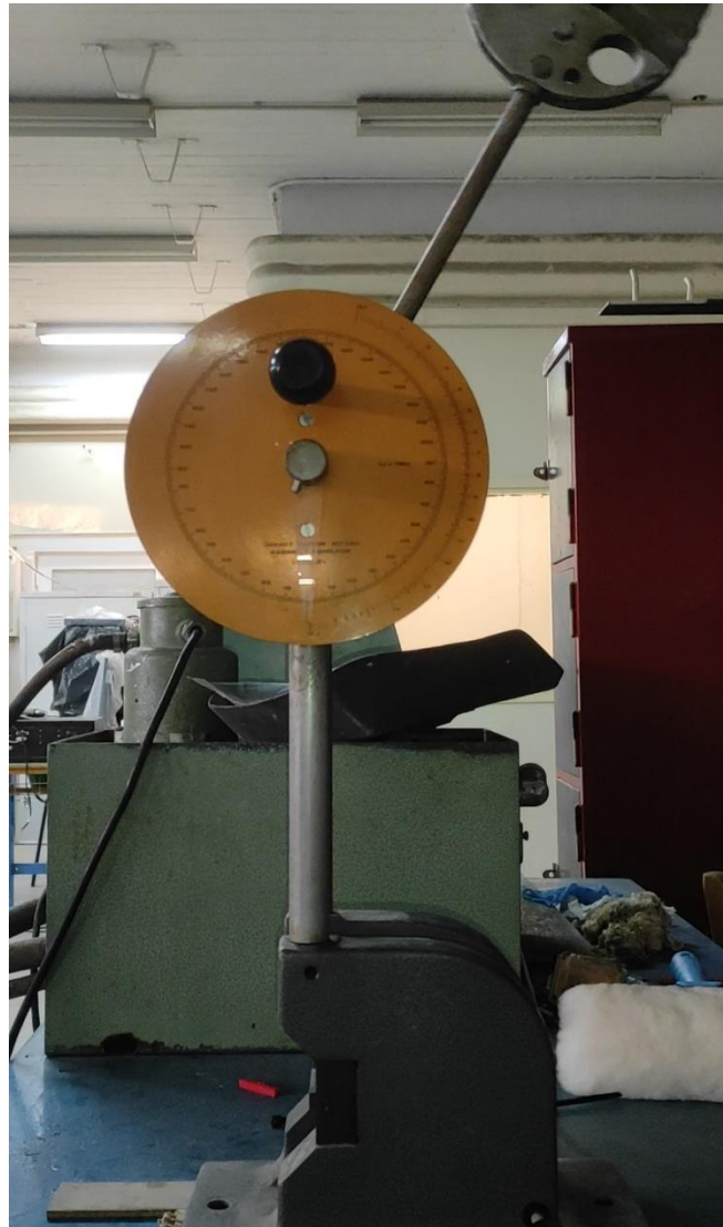
Εικόνα 77 : Τελική θέση εκκρεμούς στη δοκιμή PLA (6 mm x 6 mm x 44 mm) με τη μηχανή TERCO MT220.
