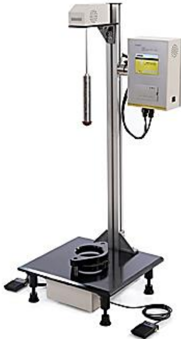
Εικόνα 18 : Πειραματική διάταξη κρούσης ελεύθερης πτώσης σώματος.
