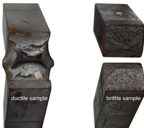
Εικόνα 11 : Αστοχία μεταλλικού υλικού μετά τη κρούση κατ' ολίσθηση και κατ' αποχωρισμό αντίστοιχα.
