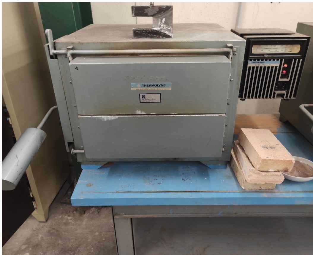
Εικόνα 56 : Ειδικός φούρνος για τη θέρμανση της σφύρας.
