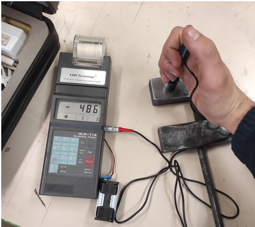
Εικόνα 61 : Μέτρηση σκληρότητας της σφύρας μετά τη κατεργασία βαφής με θετικό αποτέλεσμα στην αύξηση της σκληρότητας στα 486 HB.
