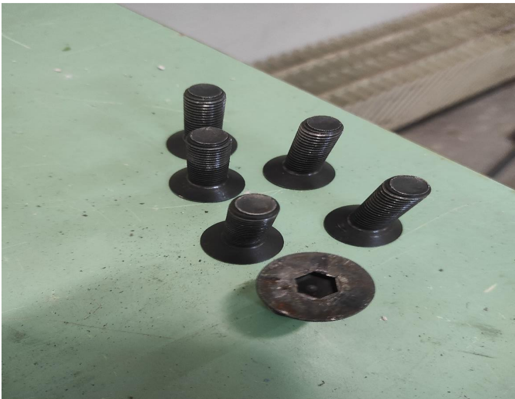
Εικόνα 43 : Κοχλίες σύνδεσης των βάσεων.
