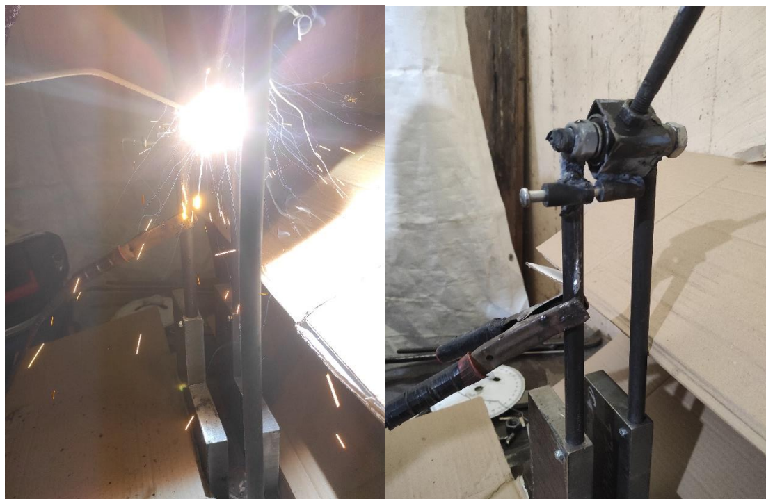
Εικόνα 66 : Συγκόλληση συστήματος απελευθέρωσης του εκκρεμούς .
