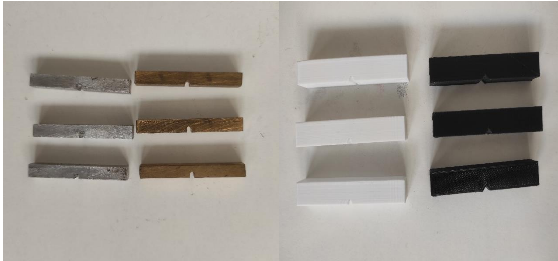
Εικόνα 71 : Δοκίμια αλουμινίου( γκρι χρώμα) , δοκίμια χυτοσιδήρου (χρυσό χρώμα) ,δοκίμια PLA (λευκό χρώμα), δοκίμια ABS (μαύρο χρώμα)
