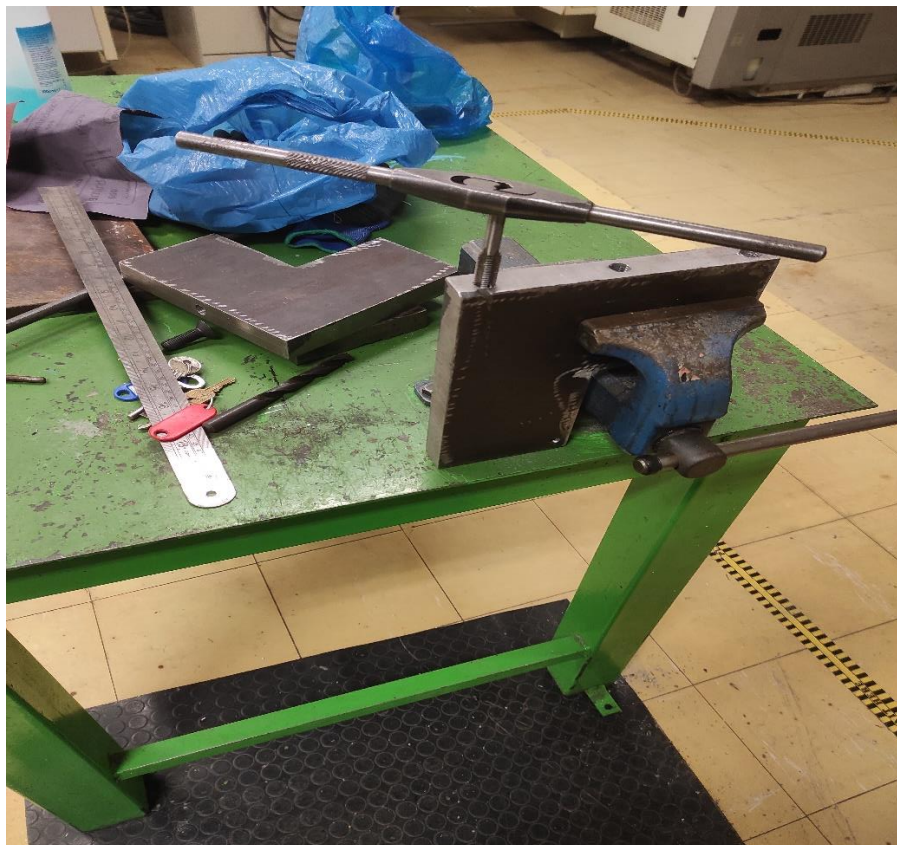
Εικόνα 46 : Χειρωνακτική διαδικασία διάνοιξης σπειρώματος.
