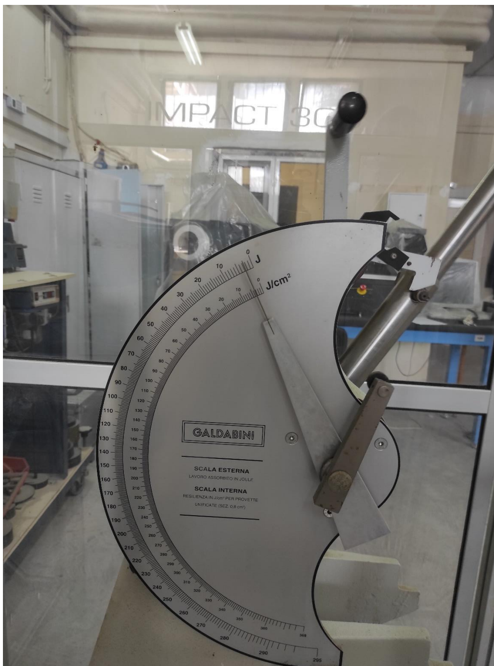
Εικόνα 74 : Σφάλμα γωνίας περιστροφής της μηχανής GALDABINI IMPACT 300.
