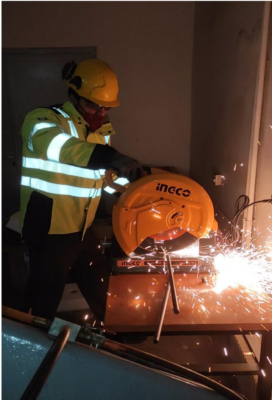
Εικόνα 49 : Διαδικασία κοπής μετάλλου με δυσκοπρίονο.
