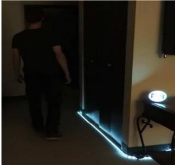
Εικόνα 5.17. Φωτεινό μονοπάτι για την υποβοήθηση της επιστροφής του ασθενή με άνοια στο κρεβάτι κατά την διάρκεια των νυχτερινών ωρών
