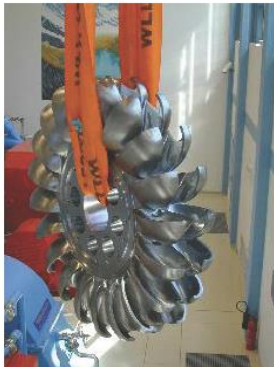
Εικόνα 4-8 Ολόσωμο τροφείο Pelton από ανοξείδωτο χάλυβα
