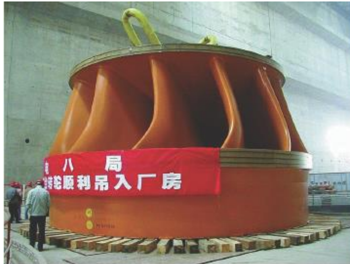
Εικόνα 4-3 Φράγμα Three Gorges (Κίνα), Υδροστρόβιλος Francis
