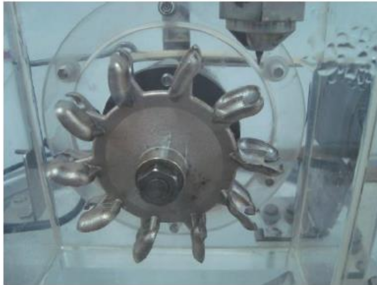
Εικόνα 4-1 Ομοίωμα υδροστροβίλου Pelton, ακροφύσιο με βελονοειδή βαλβίδα, στροφέιο με σκαφίδια
