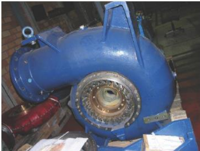
Εικόνα 4-9 Σπειροειδές κέλυφος τροφοδοσίας στροβίλων αντίδρασης με ρυθμιζόμενης κλίσης ακίνητα πτερύγια οδήγησης της ροής.
