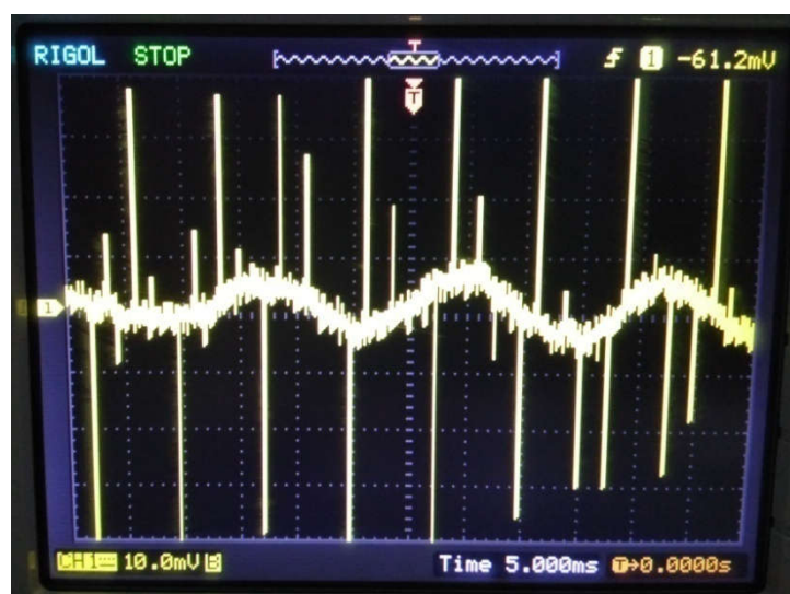
Σχ. 3.39 Θόρυβος 50Hz πάνω στον οποίο υπερτίθεται υψίσυχνος θόρυβος από τη λειτουργία 11kHz της διάταξης.
