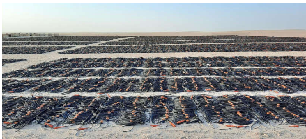
Σχ. 2.10 Στοκ από σειρές γεωφώνων στη Σαουδική Αραβία (Al Khobar, 2021). Κατά τη γεωφυσική έρευνα σε δύσβατο ορεινό ανάγλυφο τα καλώδια με τα γεώφωνα μεταφέρονται με ελικόπτερο.
