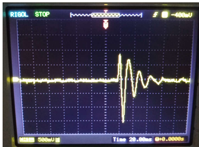
Σχ. 3.35 Καταγραφή ελαφρού χτυπήματος του σένσορα.
