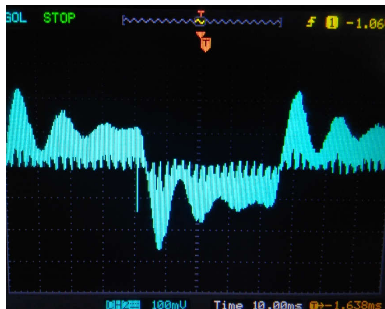
Σχ. 3.38 Η έξοδος του αποδιαμορφωτή με παλμική διέγερση.
