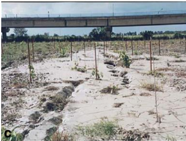
Εικόνες Διαφορετικοί τύποι ρευστοποίησης που εμφανίστηκαν κατά την διάρκεια του σεισμού
