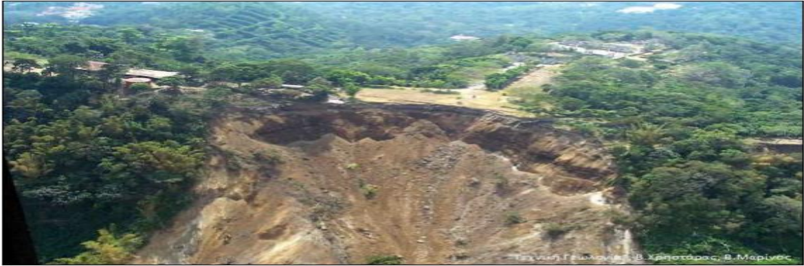
Εικόνα 2 Περιστροφική ολίσθηση βράχου, από "Τεχνική Γεωλογία" Β.Χρηστάρας, Β.Μαρίνος
