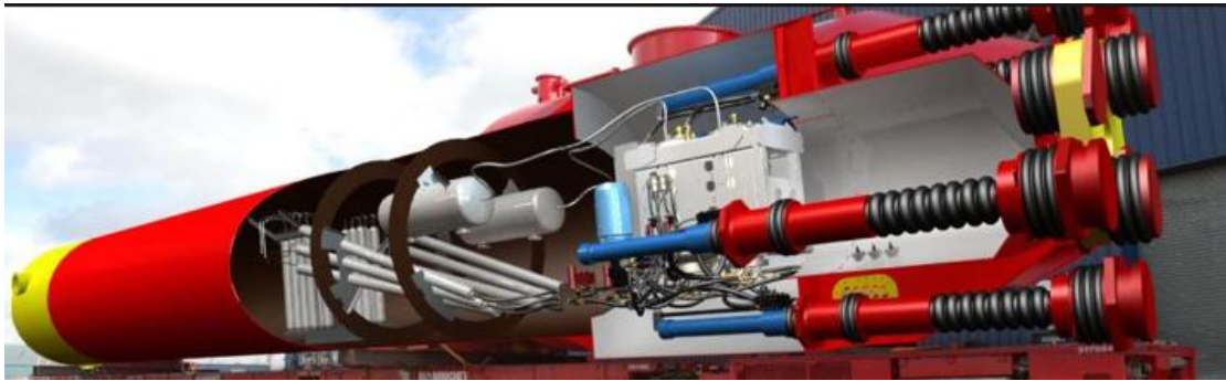
Εικόνα 4-6 Εσωτερική δομή ενός εξασθενητή
