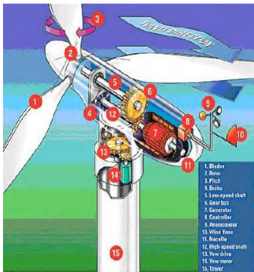
Εικόνα 2.5: Πλάγια τομή ανεμογεννήτριας και βασικά δομικά στοιχεία.
