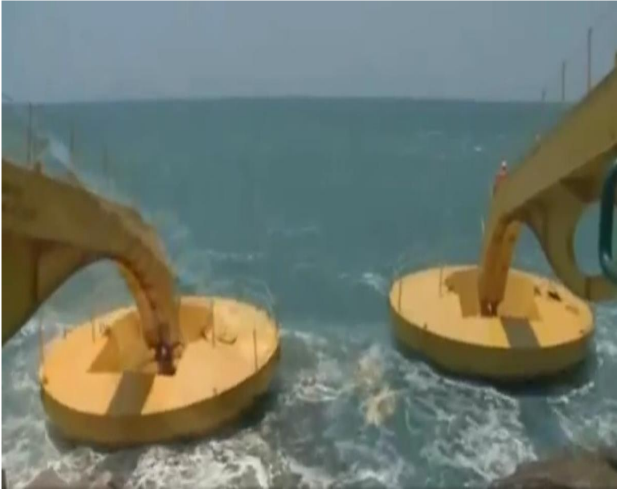
Εικόνα 6.7.2 Ραβδωτές μεταλλικές σηματοδούρες οι οποίες ενώνονται με μηχανικά χέρια στις αντλίες
