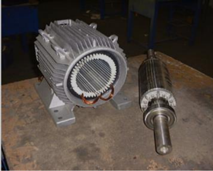
Εικόνα 1: Στάτης και δρομέας κινητήρα [1]
