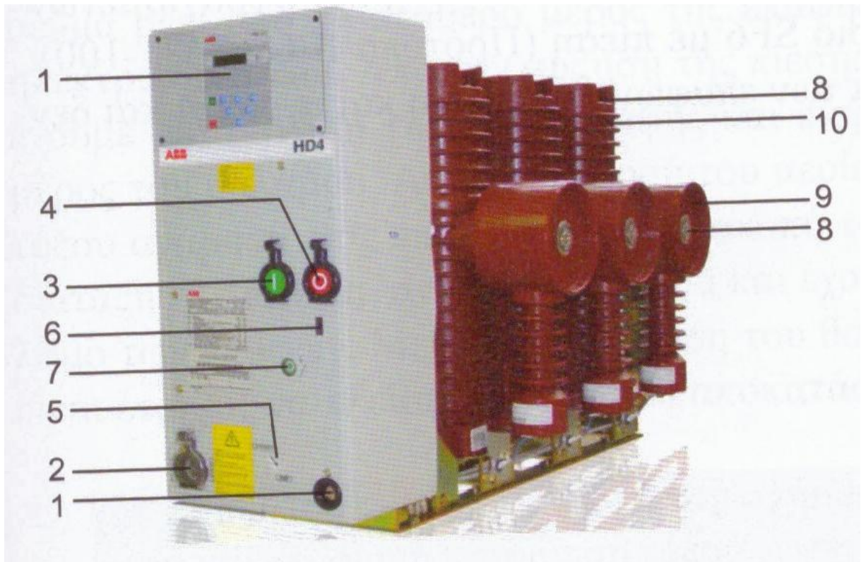
Εικόνα 6-1 Διακόπτης ισχύος μέσης τάσης με μόνωση αερίου 1.Ρελέ προστασίας 2. Άξονας για την τοποθέτηση των ελατηρίων κλεισίματος στην χειροκίνητη λειτουργία 3. Μπουτόν κλεισίματος 4.Μπουτόν έναρξης 5. Δείκτης για το κλείσιμο των ελατηρίων (κίτρινο στη φόρτιση και λευκό στην αποφόρτιση) 6. Διάταξη κλειδώματος του χώρου του αερίου SF6 υπό πίεση με σηματοδότηση (συσκευή με διακόπτη πίεσης) 7. Διακόπτες σηματοδότησης για συσκευή ανοικτή ή κλειστή 8. Ακροδέκτες μέσης τάσης 9.Αισθητήρας ρεύματος για τη λειτουργία του ρελέ προστασίας 10. Διακόπτες πόλων 11. Κλειδαριά 12.Μετρητής λειτουργίας
