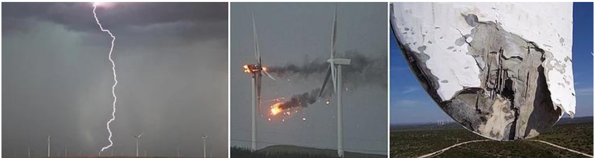
Εικόνα 5-1 Πλήγμα κεραυνού σε ανεμογεννήτριες
