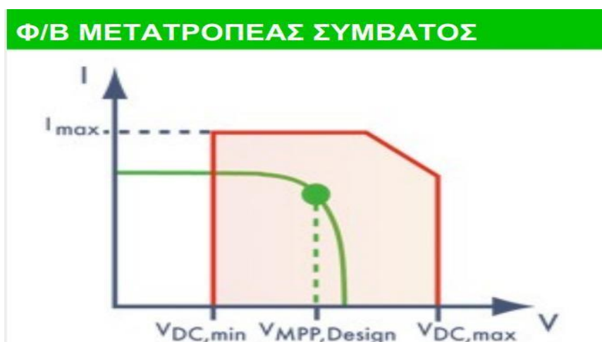
Εικόνα 31: Συμβατότητα μετατροπέα με την φωτοβολταϊκή γεννήτρια
