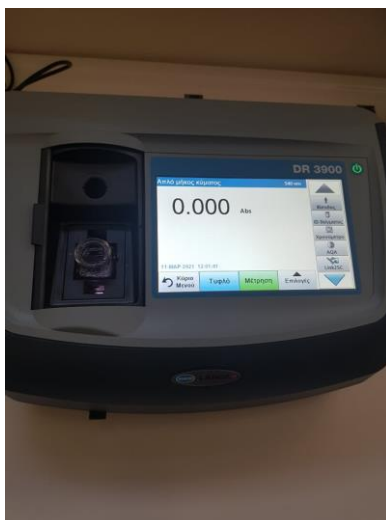
Εικόνα 19: Προετοιμασία τυφλού δείγματος στο ψηφιακό φασματοφωτόμετρο.
