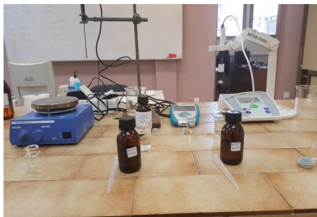
Εικόνα 15: 1 ο Αντιδραστήριο: διάλυμα sodium salicylate ( R_1 SAL) και 2 ο Αντιδραστήριο: διάλυμα sodium dichloroisocyanurate ( R_2 SDIC).
