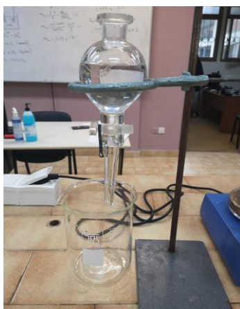
Εικόνα 30: Αποσταγμένο νερό σε διαχωριστική χοάνη των 500 ml.
