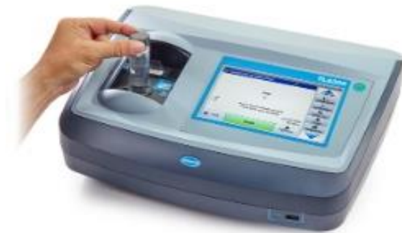
Εικόνα 6: Ενδεικτικό θολόμετρο [Πηγή: https://it.hach.com/ ]
