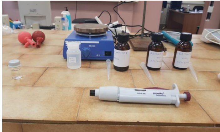
Εικόνα 17: 1 ο Αντιδραστήριο: υδροξείδιο του νατρίου (NaOH) - R1TONAQ), 2 ο Αντιδραστήριο: θειικός χαλκός (CuSO 4 ) - R 2 TONAQ και 3 ο Αντιδραστήριο: χρώματος - R 3 TONAQ
