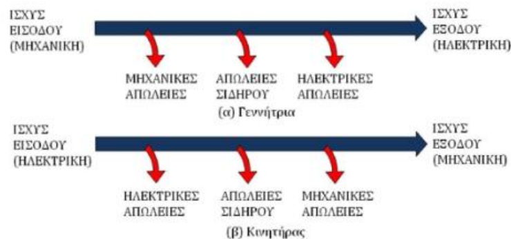
Σχ.3.1: Διάγραμμα ροής ισχύος κινητήρα συνεχούς ρεύματος, α) Γεννήτρια και β) Κινητήρας.
