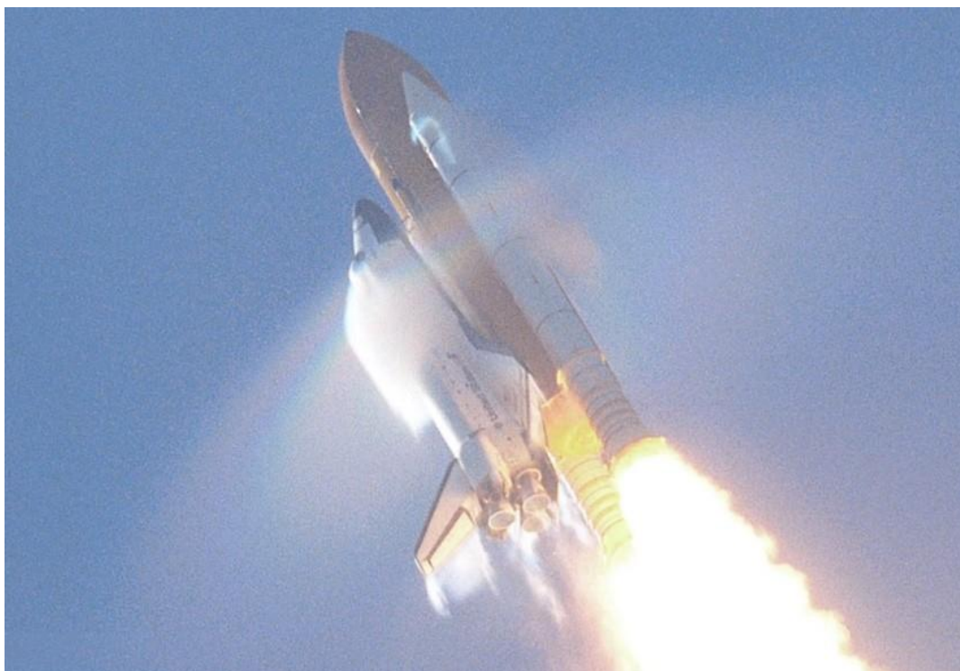
Εικόνα 33: Φωτογραφία τη στιγμή που ο πύραυλος σπάει το φράγμα του ήχου και δημιουργείται το κρουστικό κύμα. (livescience.com)
