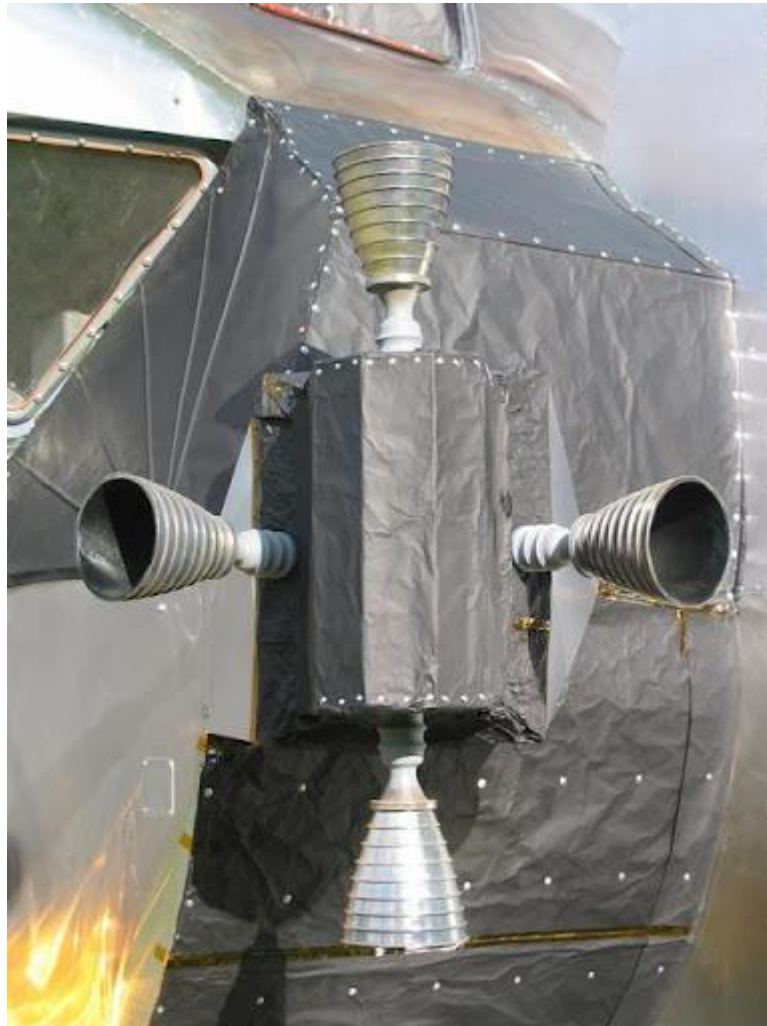
Εικόνα 47: Σύστημα ελέγχου αντίδρασης. (stevenbrower.com)
