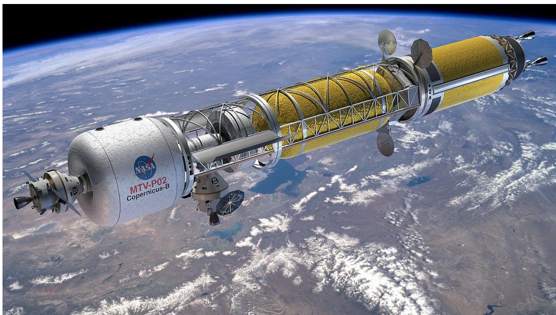
Εικόνα 17: Πρότυπο πυραύλου με πυρηνικό αντιδραστήρα το οποίο θα μένει εκτός γήινης ατμόσφαιρας και θα εξυπηρετεί μόνο για τη μεταφορά πληρωμάτων σε άλλους πλανήτες χωρίς την προσεδάφισή του. Αυτό θα προσεγγίζουν τα οχήματα που θα εκτοξεύονται από τη Γη ή άλλον πλανήτη. (phys.org)
