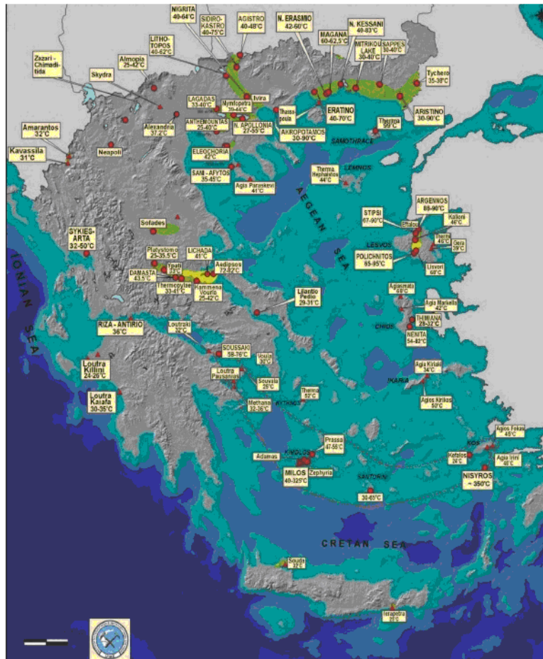
Εικόνα 9. Τα γεωθερμικά πεδία υψηλής ενθαλπίας παρουσιάζονται στις νήσους Μήλο και Νίσυρο. Αντίθετα, τα γεωθερμικά πεδία χαμηλής ενθαλπίας είναι διάσπαρτα σε όλη την Ελλάδα.
