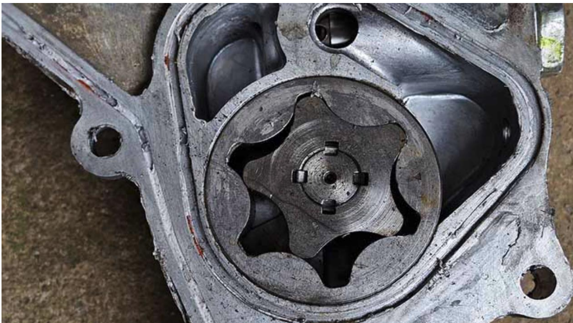
Εικόνα 3.3: Εσωτερικό αντλίας λαδιού κινητήρα εσωτερικής καύσης αυτοκινήτου (blog.beforward.jp, n.d.)
