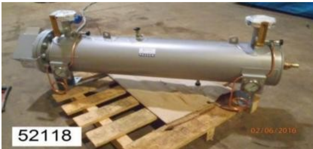
Εικόνα 70: Προθερμαντήρας ηλεκτρικού τύπου [ Electric Heaters for Preheating Lube Oil Main Engine Separators - Navkratis ]
