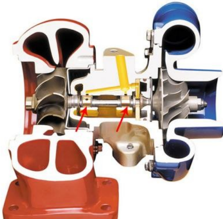
Εικόνα 51: Τομή turbo-διαδρομή ελαίου [ vtulochnayaaa.jpg (650×658) (avto-blogger.ru) ]
