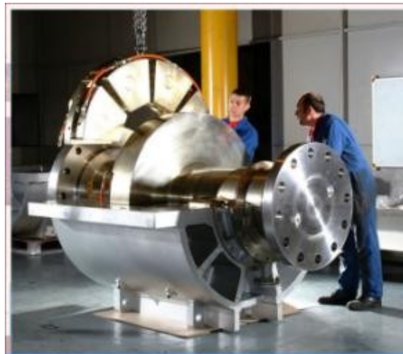
Εικόνα 57: Ωστικός τριβέας τύπου Michell [ 275122d1578803497-ot-legacy-agm-michell-1905-a-544.jpg (784×686) ( practicalmachinist.com )]
