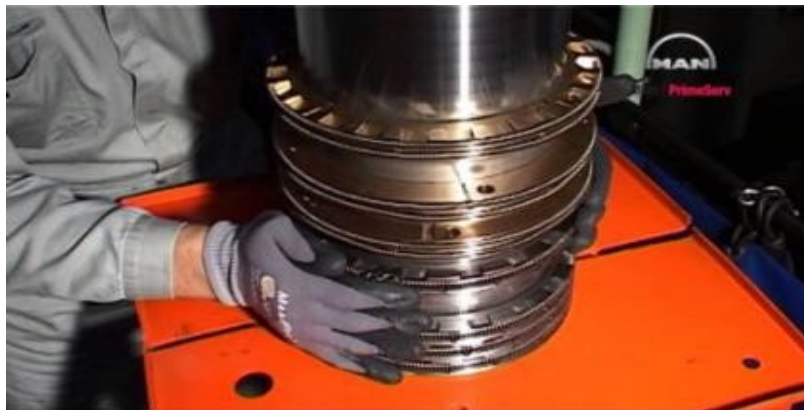
Εικόνα 46: Στεγανοποιητική διάταξη ελατηρίων [ maxresdefault.jpg (1048×576) ( yting.com )]
