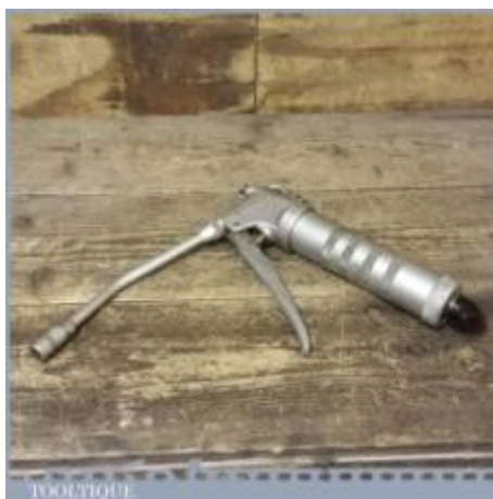
Εικόνα 17: Χειροκίνητος μηχανισμός λίπανσης [ T3696-2-1024x1024.jpg (1024×1024) ( tooltique.co.uk )]
