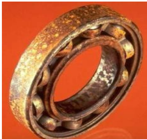
Εικόνα 13: Ρουλιάν με διάβρωση [corrosive wear mechanism - Bing images]
