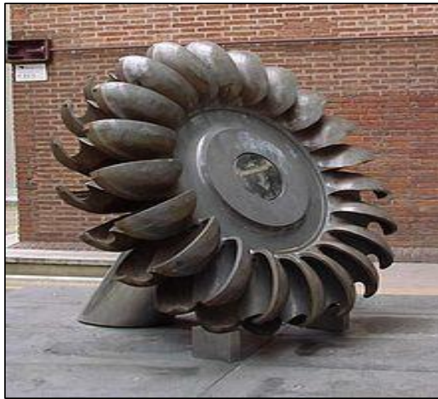
Εικόνα 22: Υδροστρόβιλος Pelton και τα κύπελλα με διπλή κοιλότητα [Πηγή: https://core.ac.uk/download/pdf/228081165.pdf ]
