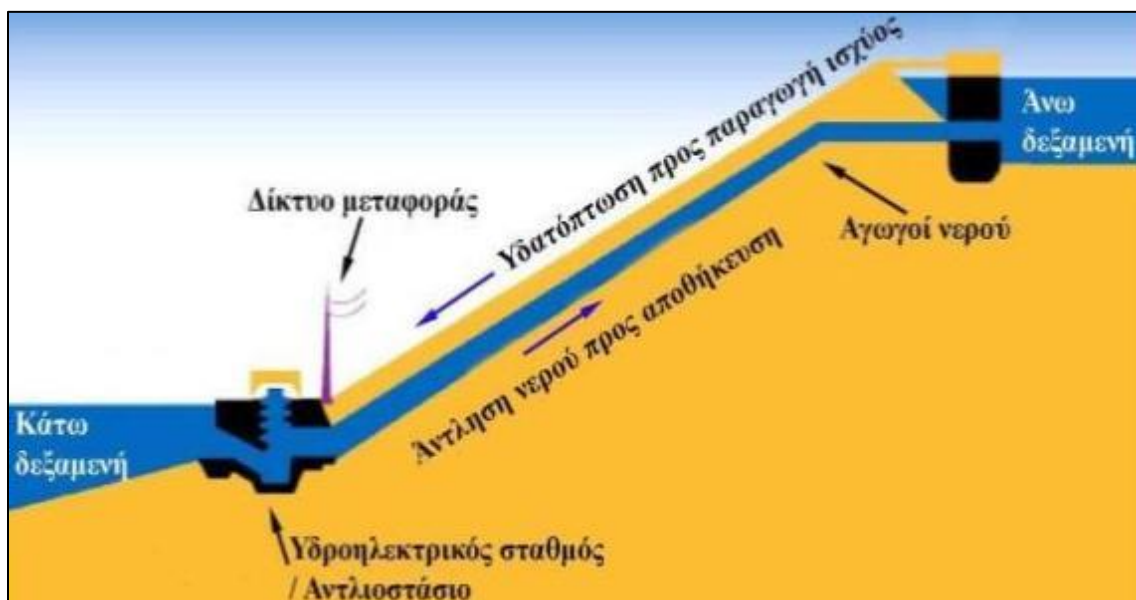
Εικόνα 3: Σταθμός αντλιών [Πηγή: Βικιπαίδεια Σταθμός αντλιών]
