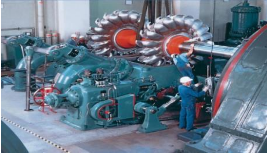
Εικόνα 23: Υδροστρόβιλος Pelton, οριζοντίου τύπου [Πηγή: https://core.ac.uk/download/pdf/228081165.pdf ]
