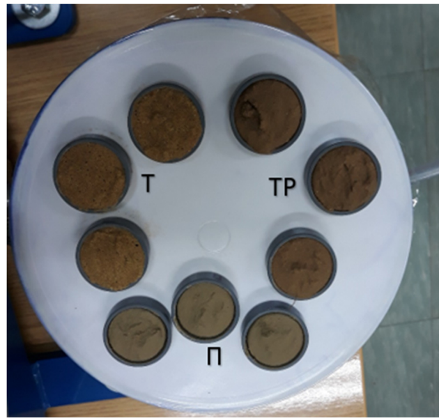
Εικόνα 8.14 Η εισαγωγή και η εξαγωγή των δειγμάτων στη τράπεζα πίεσης
