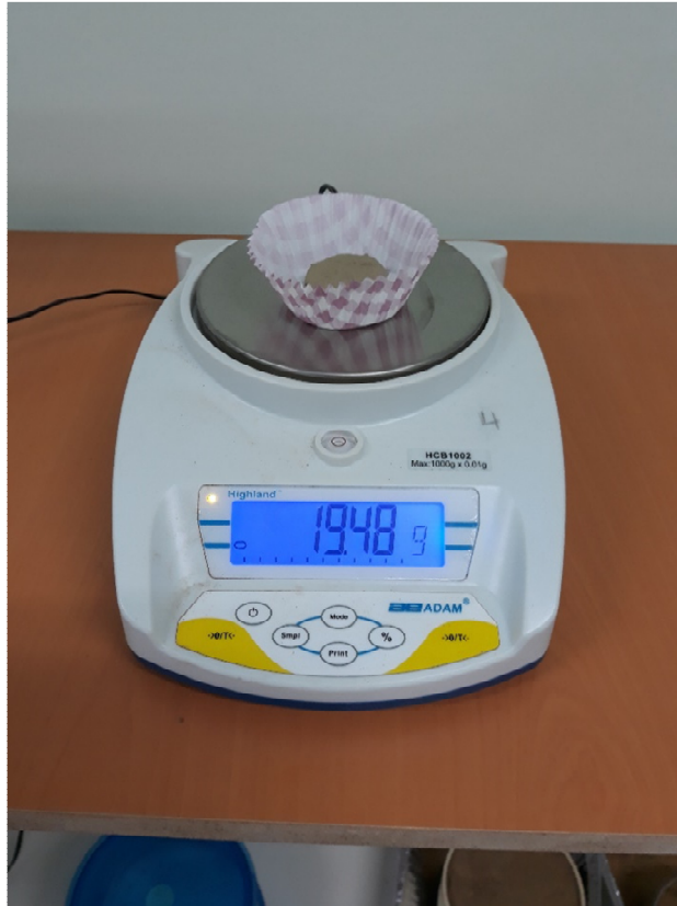
Εικόνα 5. 27: Ζύγιση χάρτινου σκεύους μαζί με το δείγμα μετά την εξαγωγή του από το πυραντήριο.
