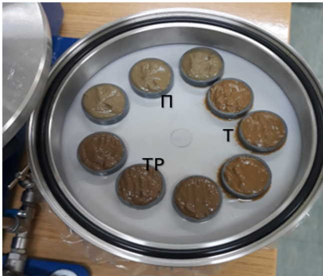
Εικόνα 8.13 Η εισαγωγή και η εξαγωγή των δειγμάτων στη τράπεζα πίεσης
