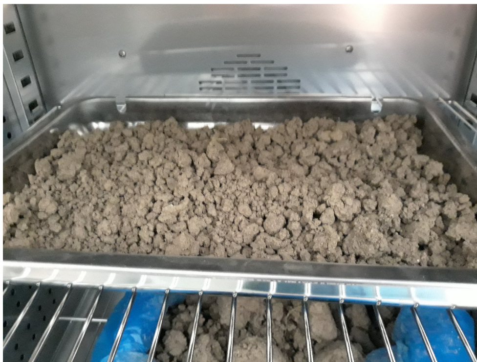
Εικόνα 5.12 Εισαγωγή των δειγμάτων στο φούρνο ξήρασης στους 33 βαθμούς Κελσίου.
