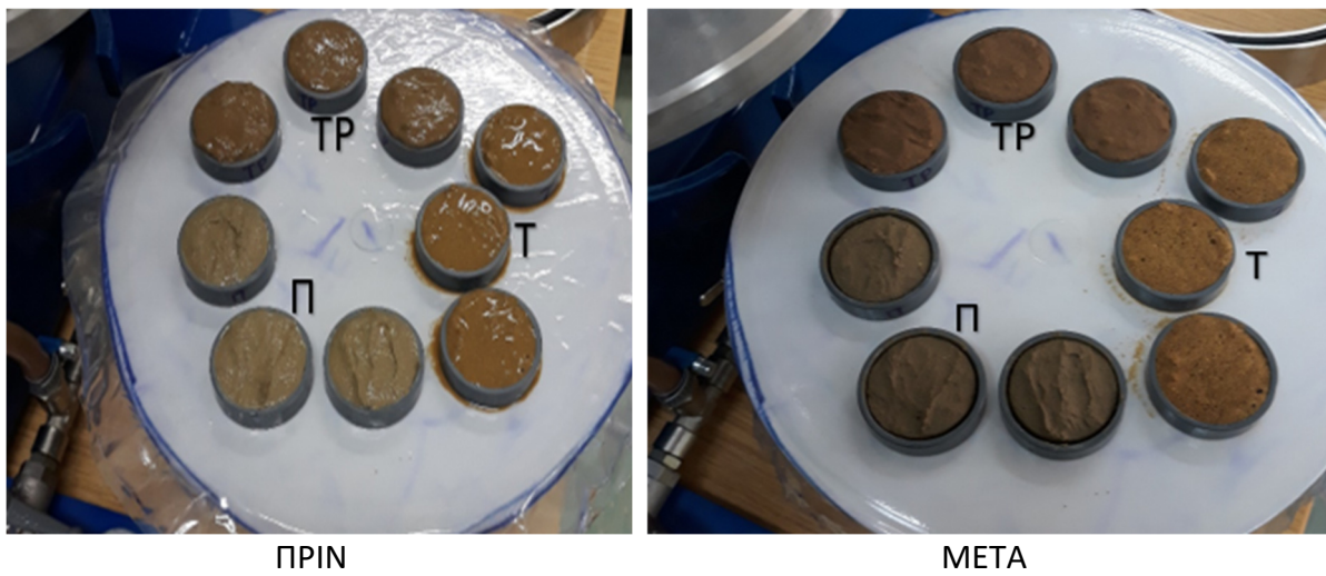
Εικόνα 8.8 Η εισαγωγή και η εξαγωγή των δειγμάτων στη τράπεζα πίεσης.
