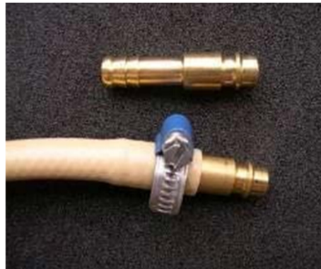
Εικόνα 5.4 Συνδεσμολογία σωλήνα αέρα υψηλής πίεσης
