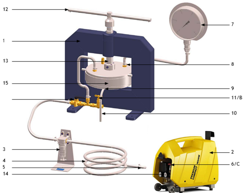
Εικόνα 5.2 Συσκευή Pressure Membrane Apparatus με αριθμημένα εξαρτήματα
