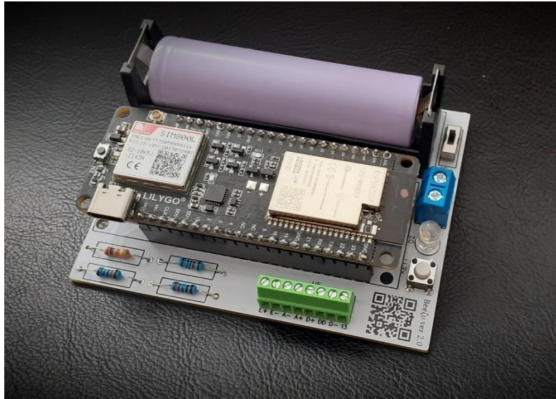
Εικόνα 33: PCB μελισσοκομικής ζυγαριάς (1)
